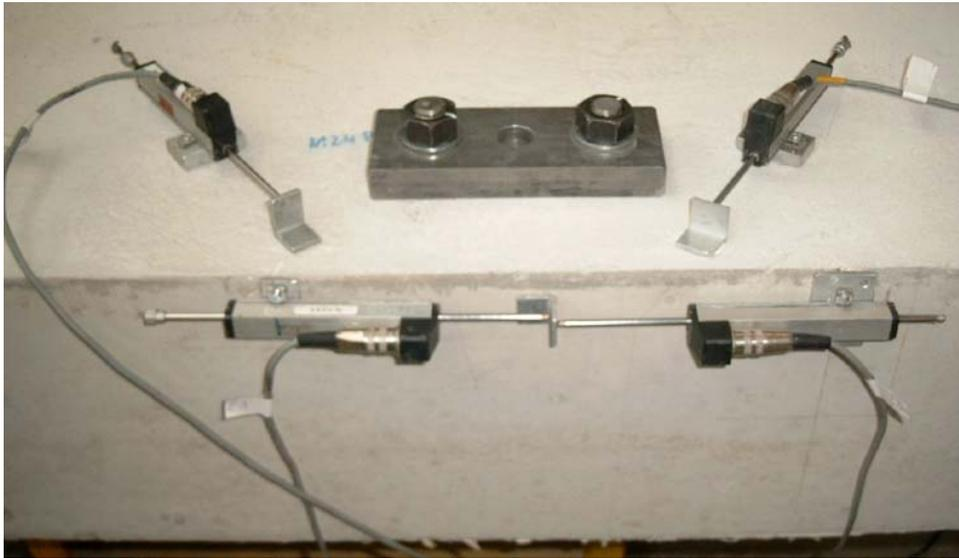
Abbildung 3.5: Versuchsaufbau Montageversuch
