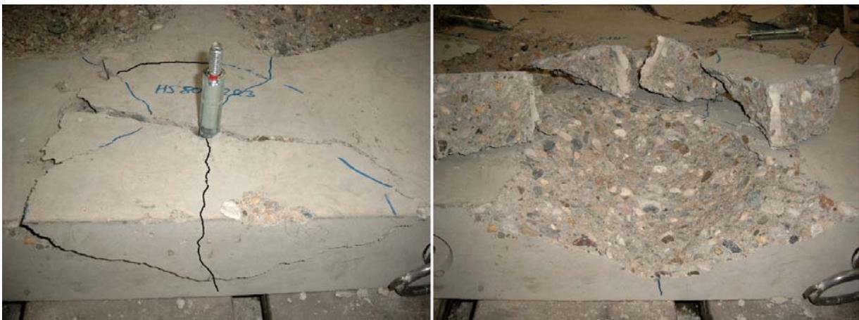
**Abbildung 5.36:** Rissbild und Bruchkörper eines Einzeldübel am Rand bei geringer Bauteildicke
