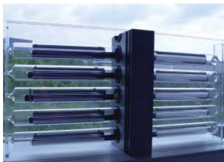
Abb. 10.11 Mock-up M 1:1 mit Teildurchsicht
