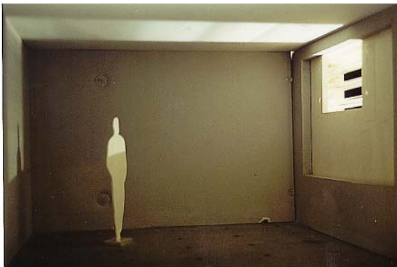
Abb. 7.35 Einbausituation Oberlicht bei einer Sonnenhöhe von 60°
