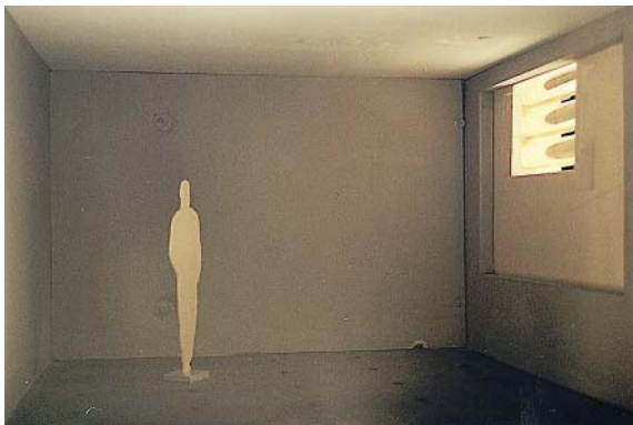
Abb. 7.56 Einbausituation Oberlicht bei einer Sonnenhöhe von 60°
