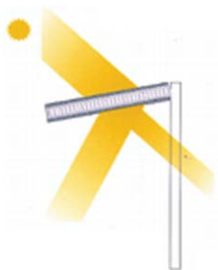
Abb. 5.19 Funktionsweise von Inglas-Y beim Einbau in eine Schrägverglasung
