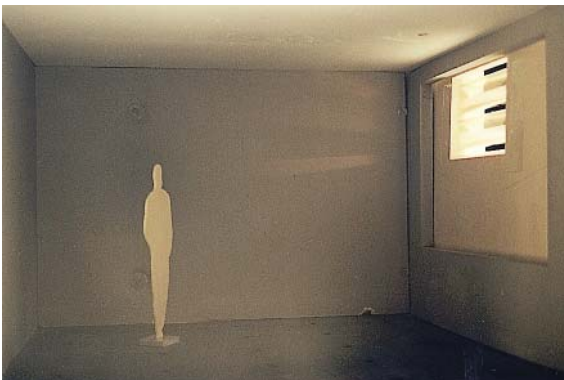
Abb. 7.49 Einbausituation Oberlicht bei einer Sonnenhöhe von 60°
