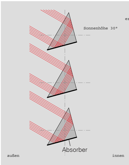
Abb 8.126 90° -Prisma mit einer matt grau absorbierenden Kathete bei einer Sonnenhöhe von 30°
