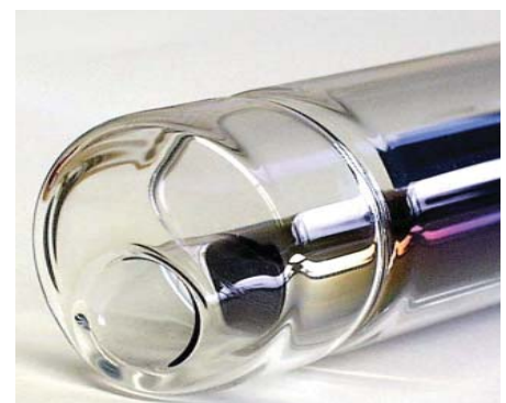
Abb. 9.06 Verschmelzung Absorberrohr und Hüllrohr
