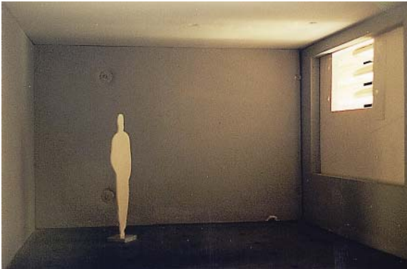
Abb. 7.55 Einbausituation Oberlicht bei einer Sonnenhöhe von 15°
