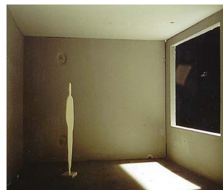
Abb. 7.05 Modellraum ohne Lichtlenkelement als Referenz
