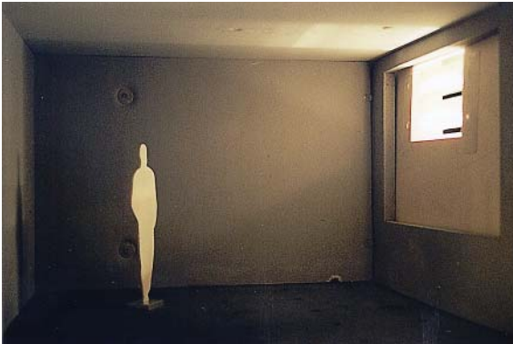
Abb. 7.48 Einbausituation Oberlicht bei einer Sonnenhöhe von 15°
