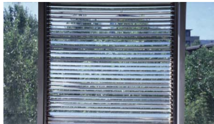
Abb. 10.36 Fassaden mock-up mit Teildurchsicht
