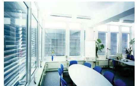
Abb. 8.36 Projektbeispiel: Oben: Lumitop®-Elemente im Oberlichtbereich. Unten: Innenansicht bei aktiviertem Sonnenschutz [KLEIN 2000 L10]
