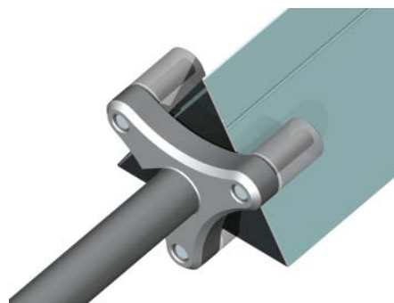
Abb. 10.28: 3d-Darstellung Variante 2 zur Prismenhalterung
