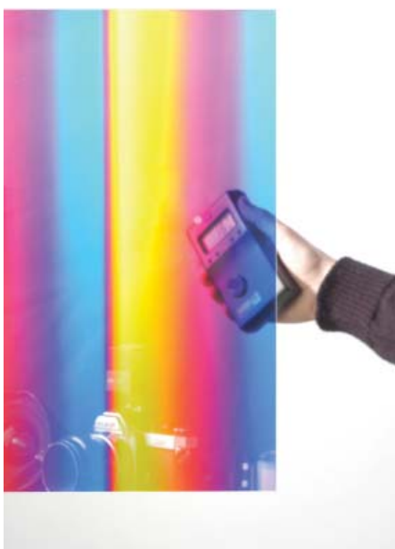
Abb. 5.35 Hologramm mit freier Durchsicht [GLB]
