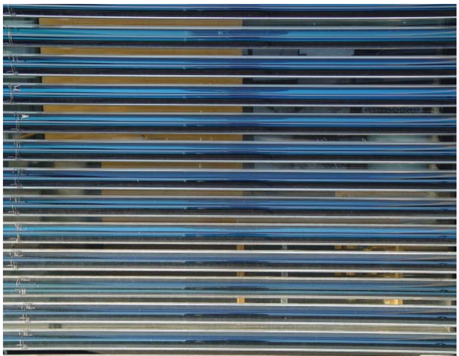
Abb. 10.35 Vakuumröhren mit Teildurchsicht
