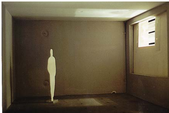
Abb. 7.42 Einbausituation Oberlicht bei einer Sonnenhöhe von 60^\circ
