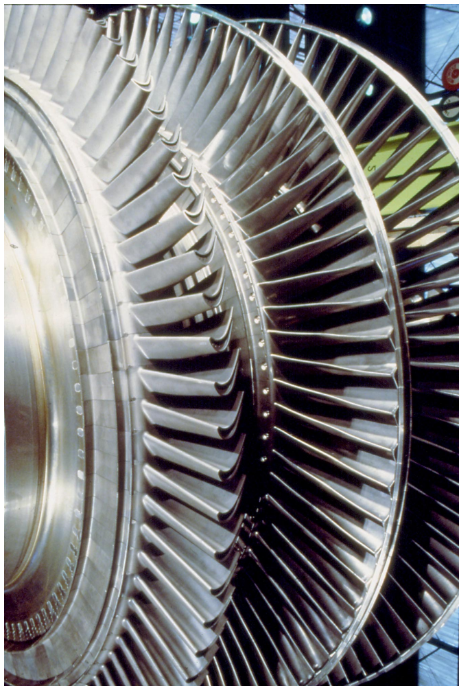
Bild 3.1 : Schaufel-Scheibe-Verbindung einer Gasturbine (Bildnachweis: General Electric Power Systems)
