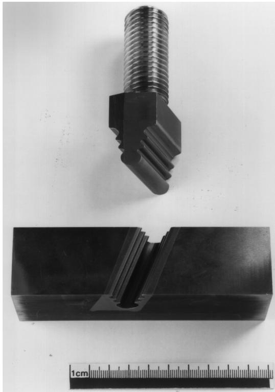
Bild 4.16: Modellkörper für Schaufel-Scheibe-Verbindungen
