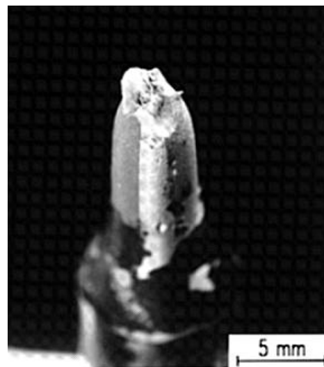
Bild B 5.9: Werkstoff X6 CrNi 18 11: Bruchfläche der Rundzugprobe BS8 ( \dot{\epsilon}_{pl} = 1323 \text{ s}^{-1} ).
