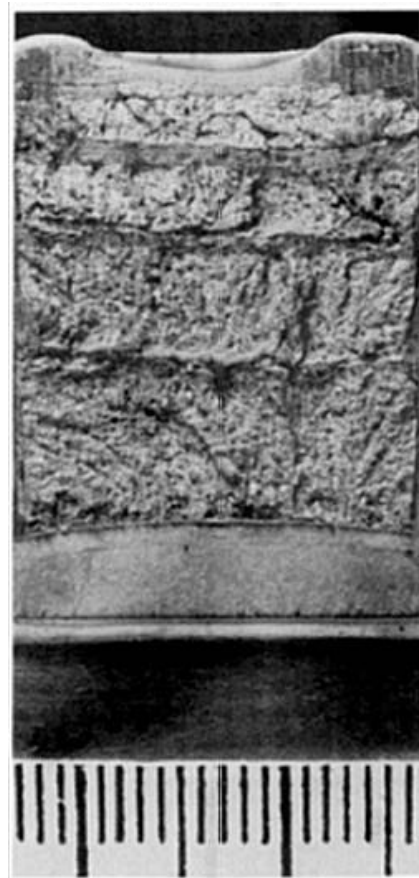
Bild B 6.9: 10 MnMoNi 5 5 (formgeschweißt): Bruchflächen der angeschwungenen CT25-Proben FS705 ( v = 10 \text{ m/s} ; \dot{K} = 1,2 \times 10^6 \text{ MPa}\sqrt{\text{m/s}} )
