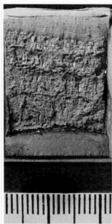
Bild B 6.8: 10 MnMoNi 5 5 (formgeschweißt): Bruchflächen der angeschwungenen CT25-Proben FS695 ( v = 0,8 \text{ mm/s} ; \dot{K} = 1,2 \times 10^5 \text{ MPa}\sqrt{\text{m/s}} )
