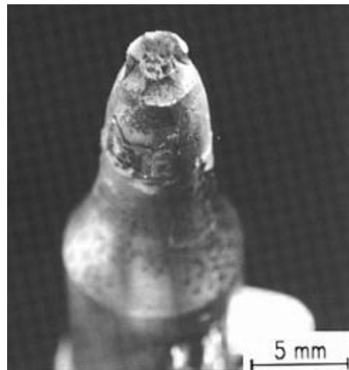
Bild B 5.4: Werkstoff 20 MnMoNi 5 5: Bruchfläche der Rundzug- probe S8 ( \dot{\epsilon}_{pl} = 1032 \text{ s}^{-1} ).
