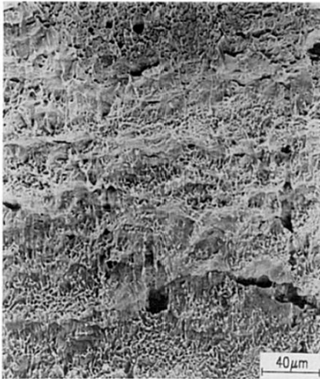
Bild B 6.22: 17 MnMoV 6 4 (WB35): Stretched Zone der erodiergekerbten CT10-Proben D13 ( v = 5 \text{ m/s} ; \dot{K} = 1,1 \times 10^6 \text{ MPa}\sqrt{\text{m/s}} )
