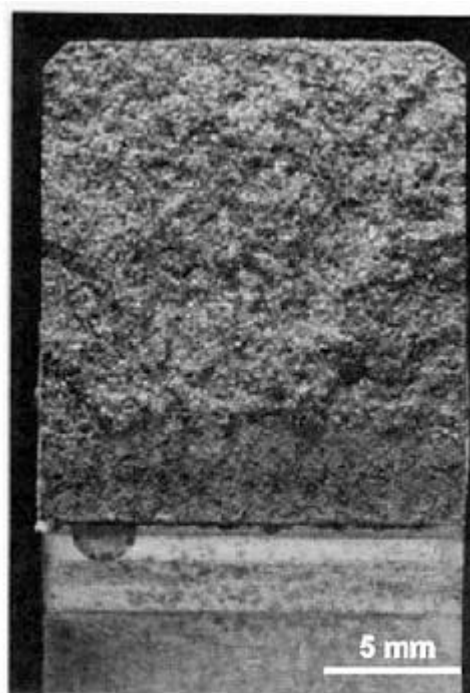
Bild B 6.32: Werkstoff GGG 40 (duktils Gußeisen): Bruchflächen der Proben GGG32 (0,01 mm/s; 0,23 MPa \dot{\epsilon} m/s) und GGG35 (5 m/s; 6,7x10 5 MPa \dot{\epsilon} m/s)
