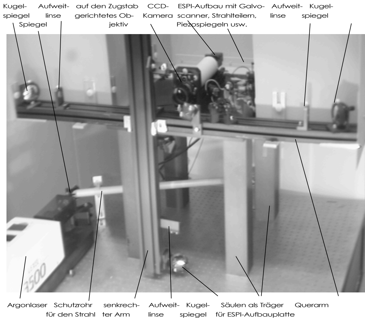
Bild 5.1: Frontansicht des vierarmigen Aufbaus
