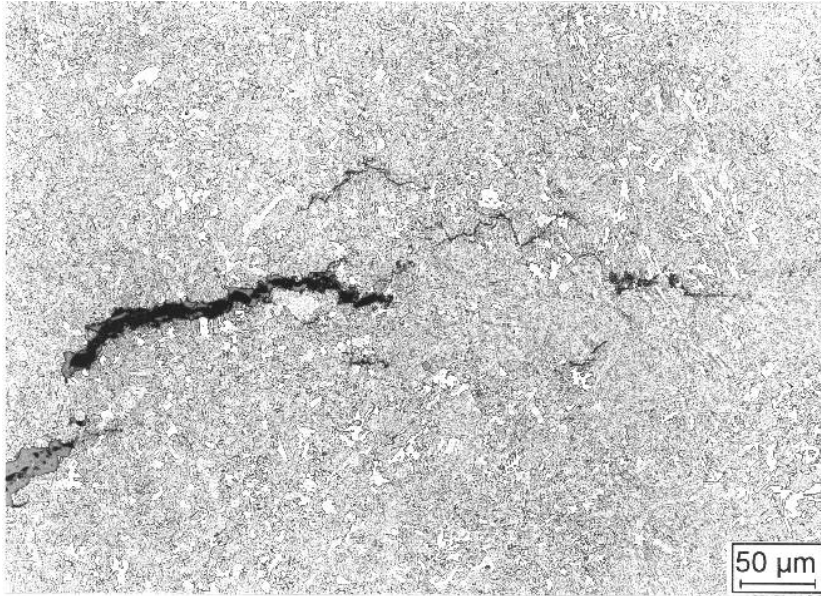
Bild A10.3: Spitze des Kriechermüdrisses nach 8080 h Beanspruchungsdauer, interkristalline Werkstofftrennung
