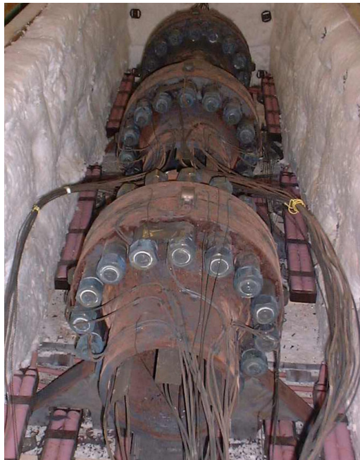
Bild 3.37 : Flansche nach der ersten Auslagerung im Ofen
