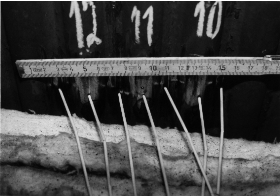
Abbildung 7-2: Angepunktete Thermoelemente an der Rückwand Nr. 5 – außen
