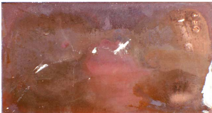
Farbabb. 31: Kupferbleche nach Entfernung des Gipses, Auslagerung 24 Monate in bewittertem Außenklima (oben: in Stuckgips Naturgips; Mitte: in Stuckgips Naturgips + \text{Ca}(\text{OH})_2 ; unten: in Stuckgips REA-Braunkohle)
