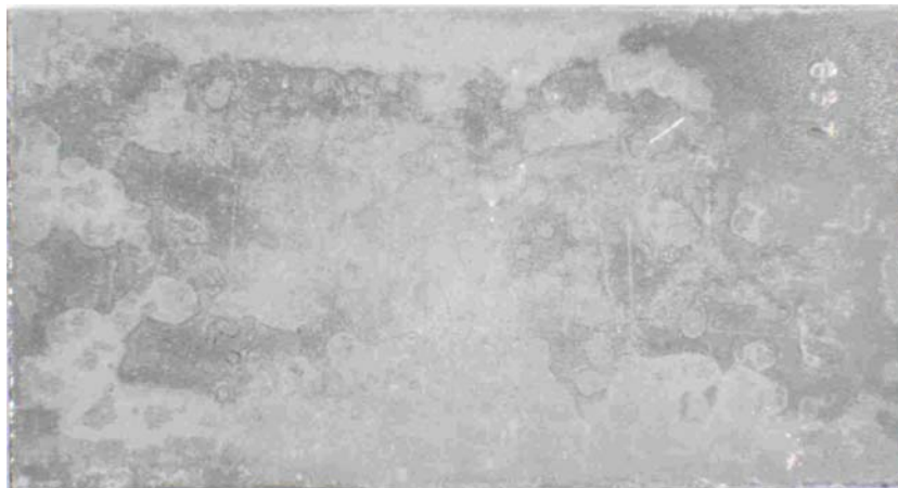
Farbabb. 19: Sendzimirverzinkte Stahlbleche nach Entfernung des Gipses, Auslagerung 24 Monate bei 75% relativer Luftfeuchte (oben: in Stuckgips Naturgips; unten: in Stuckgips REA-Braunkohle)
