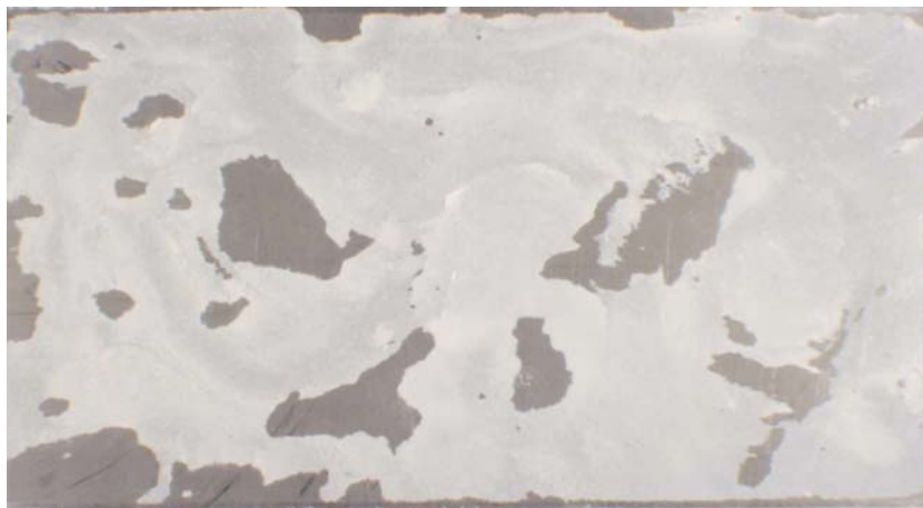
Farbabb. 25: Nichtrostendes Stahlblech nach Entfernung des Stuckgipses Naturgips (exemplarisch Auslagerung 24 Monate bei 100% relativer Luftfeuchte mit Vortrocknung)
