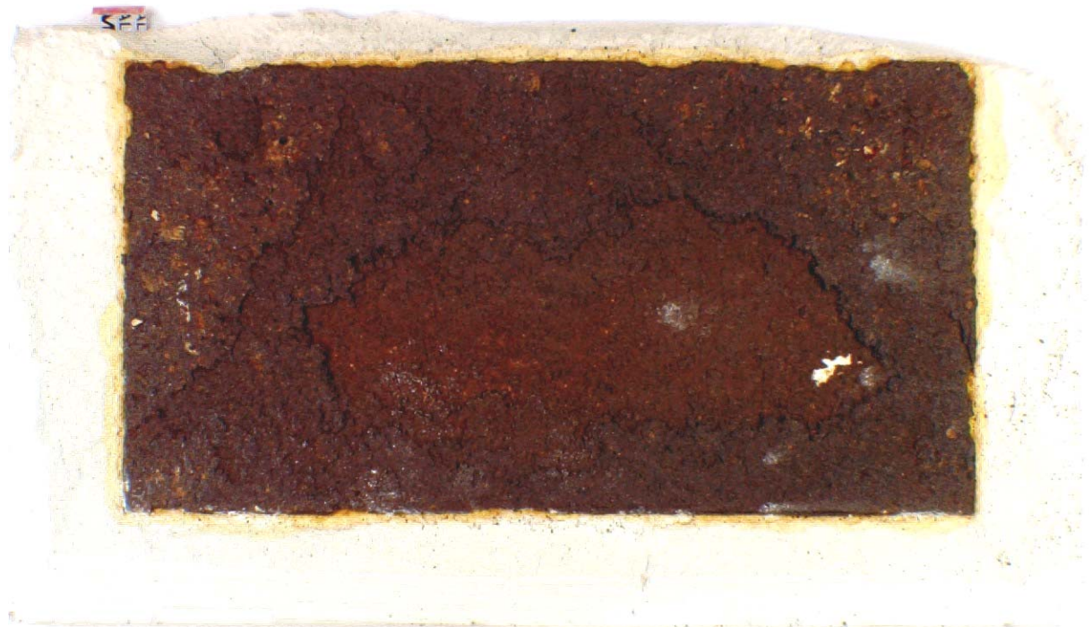
Farbabb. 11: Unlegiertes Stahlblech nach Entfernung des Stuckgipses REA-Braunkohle, Auslagerung 24 Monate bei 95% relativer Luftfeuchte (oben: Stahl ohne Gips; unten: Gips mit Korrosionsprodukten)
