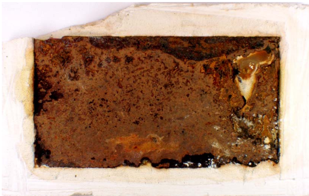
Farbabb. 8: Unlegiertes Stahlblech nach Entfernung des Stuckgipses Naturgips, Auslagerung 24 Monate bei 100% relativer Luftfeuchte mit Vortrocknung (oben: Stahl ohne Gips; unten: Gips mit Korrosionsprodukten)
