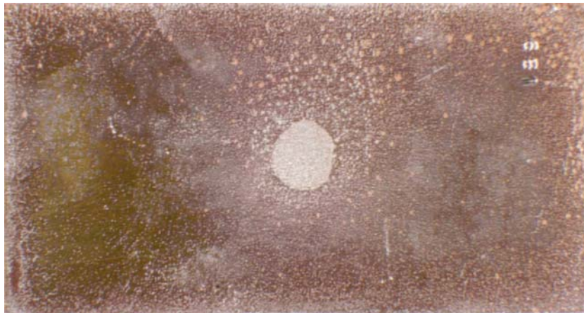
Farbabb. 38: Zinkreiche Messingbleche nach Entfernung des Gipses, Auslagerung 24 Monate bei 75% relativer Luftfeuchte (oben: in Stuckgips Naturgips; unten: in Stuckgips REA-Braunkohle)
