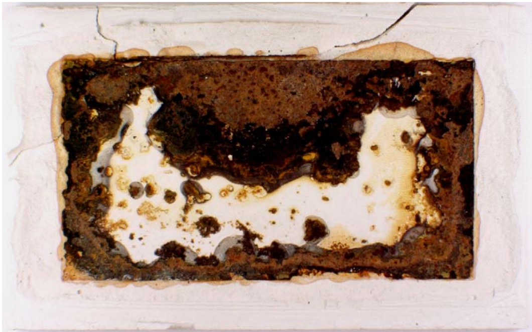
Farbabb. 9: Unlegiertes Stahlblech nach Entfernung des alkalisierten Stuckgipses Naturgips, Auslagerung 24 Monate bei 100% relativer Luftfeuchte mit Vortrocknung (oben: Stahl ohne Gips; unten: Gips mit Korrosionsprodukten)
