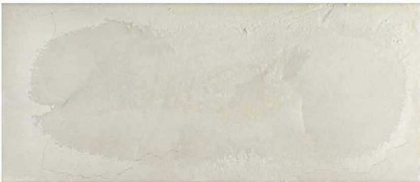
Farbabb. 22: Eloxierte Aluminiumbleche (AlMgSi0,5) nach Entfernung des Gipses, Auslagerung 3 Monate bei 100% relativer Luftfeuchte ohne Vortrocknung (oben: in Stuckgips Naturgips; unten: in Stuckgips Naturgips + Ca(OH) 2 )
