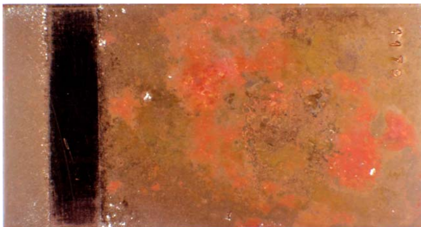
Farbabb. 30: Kupferbleche nach Entfernung des Gipses, Auslagerung 24 Monate in unbewittertem Außenklima (oben: in Stuckgips Naturgips; Mitte: in Stuckgips REA-Braunkohle; unten: kontaminiert mit Naturgips, Streifen von Probenhalter)
