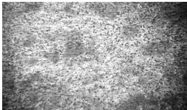
Abbildung 6.17: Korrosionsangriff an unlegiertem Stahl in \text{CaSO}_4 -Lösung (Sulfatkonzentration: 0,014 \text{ mol/l} ) bei pH 11,5 (25-fache Vergrößerung)
