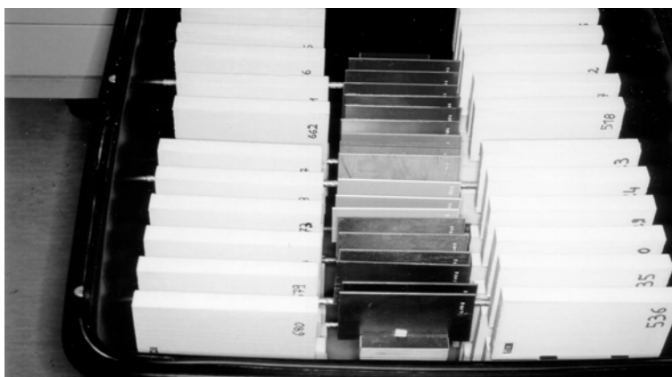
Abbildung 10.3: Auslagerung der Probekörper in Klimakammern über gesättigter NaCl-Lösung (konst. 75% rel. Feuchte) bzw. über gesättigter KCl-Lösung (konst. 95% rel. Feuchte) bei 20° C
