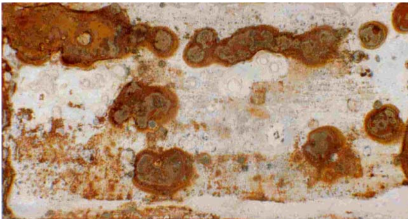
Farbabb. 16: Sendzimirverzinkte Stahlbleche nach Entfernung des Gipses, Auslagerung 24 Monate bei 100% relativer Luftfeuchte mit Vortrocknung (oben: in Stuckgips Naturgips; unten: in Stuckgips REA-Braunkohle)
