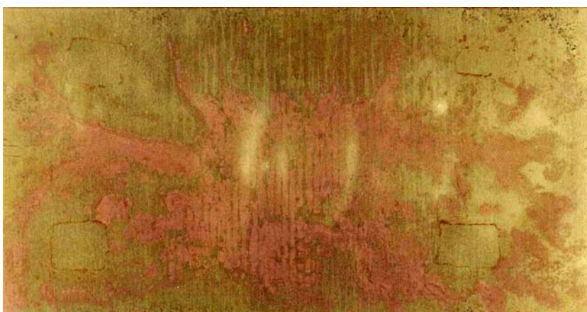
Farbabb. 41: Messing CuZn39Pb2 nach Entfernung des Stuckgips REA-Steinkohle, Auslagerung 10 Tage mit einmaliger, kurzzeitiger Wasserlagerung (Korrosionsprodukte abgebeizt)
