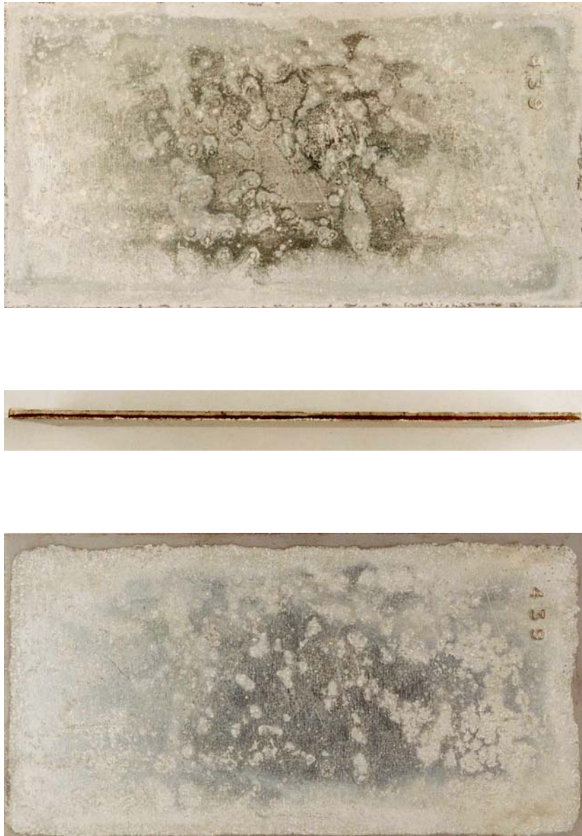
Farbabb. 17: Sendzimirverzinkter Stahl nach Entfernung des Stuckgipses REA-Braunkohle, Auslagerung 3 Monate bei 95% relativer Luftfeuchte (oben: nach Entnahme; Mitte: Kantenfläche; unten: Korrosionsprodukte abgebeizt)
