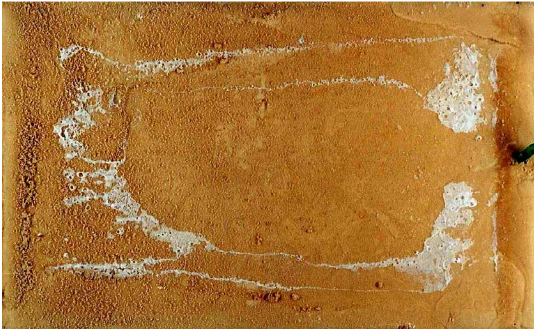
Farbabb. 42: In alkalisiertem Stuckgips REA-Braunkohle eingebettetes zinkreiches Messing CuZn39Pb2 nach Durchführung der elektrochemischen Untersuchungen
