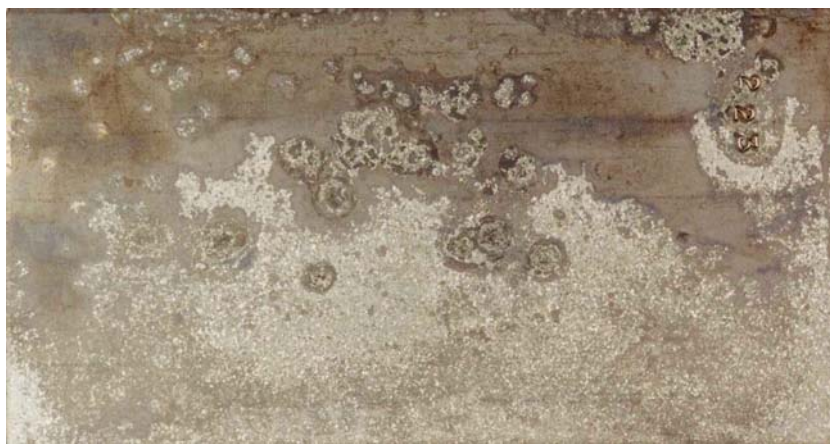
Farbabb. 15: Sendzimirverzinkter Stahl nach Entfernung des Stuckgipses REA-Braunkohle, Auslagerung 3 Monate bei 100% relativer Luftfeuchte mit Vortrocknung (oben: nach Entnahme; unten: Korrosionsprodukte abgebeizt)
