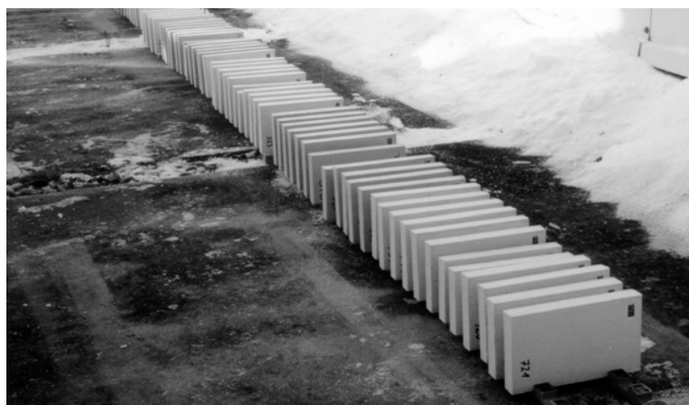
Abbildung 10.4: Auslagerung der Probekörper an bewitterter Atmosphäre auf dem Dach des Otto-Graf-Instituts, Universität Stuttgart
