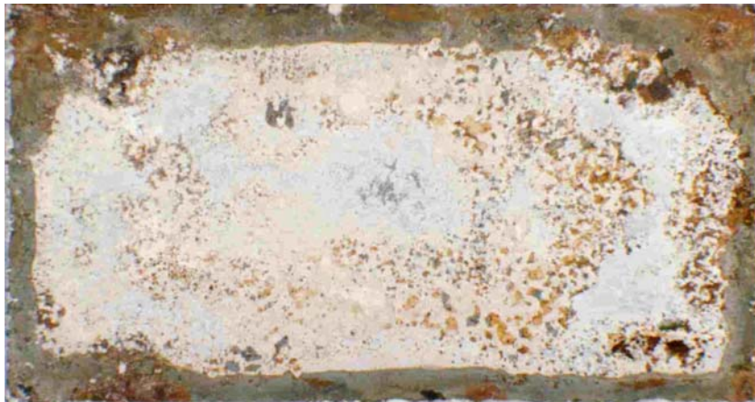
Farbabb. 18: Sendzimirverzinkte Stahlbleche nach Entfernung des Gipses, Auslagerung 24 Monate bei 95% relativer Luftfeuchte (oben: in Stuckgips Naturgips; unten: in Stuckgips REA-Braunkohle)
