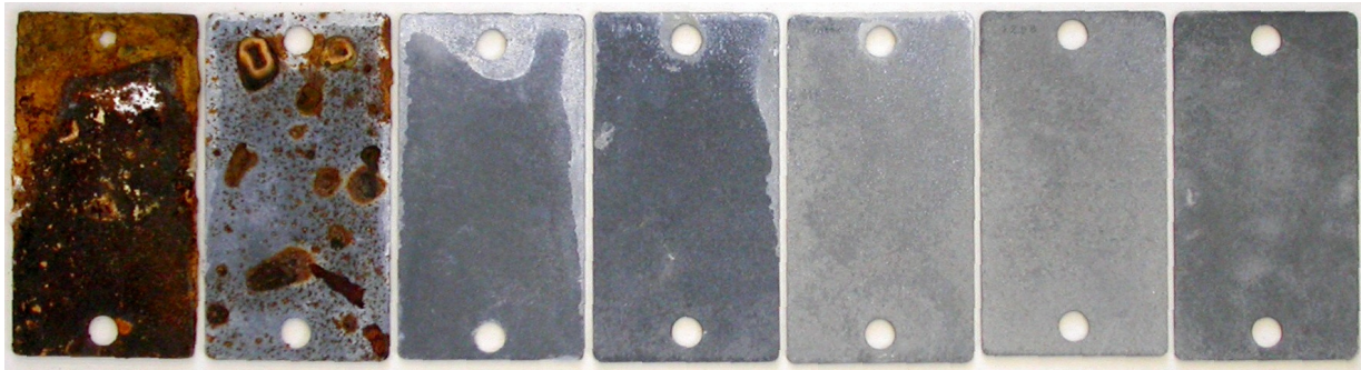
Abb. 19 : Aussehen der Proben nach 5 Jahren Auslagerung im Boden mit Salzzugabe (v.l.n.r.: Zn, ZnAl2, ZnAl4, ZnAl15, ZnAl, ZnAlMg5, ZnAl22)
