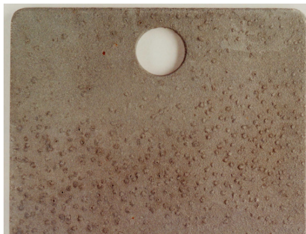
Abb. 17 : ZnAl2-Probe nach 2 Jahren Auslagerung in Boden ohne Salzzugabe; starke Blasenbildung
