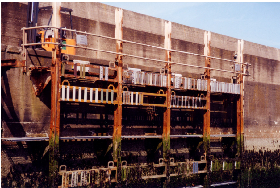
Abb. 10 : Meerwasserversuchsstand des Otto-Graf-Institutes auf Helgoland. Erkennbar ist oben die Spritzwasserzone und unten der Bereich der Wechselltauchzone
