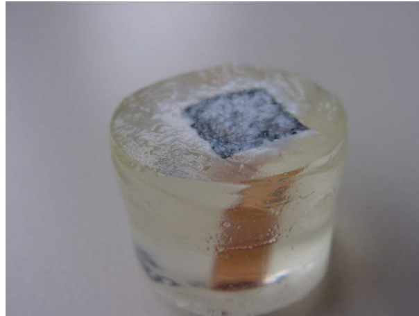
Abb. 59: Während der Messung gebildete gelartige Deckschicht
