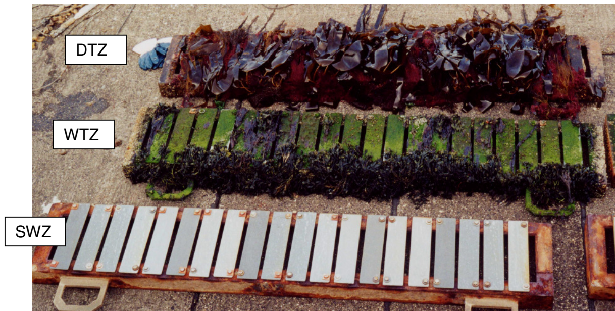
Abb. 22 : Aussehen der Proben direkt nach der Entnahme nach 5 Jahren Auslagerung im Meerwasser
