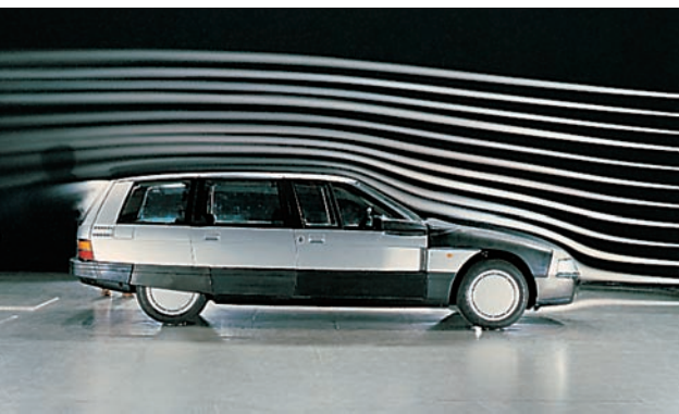
Umströmung eines Prototyps des Forschungs-Pkw Uni-Car mit Rauchfäden im Windkanal.
