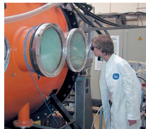
Versuchsanlage des IRS: Vakuumtank zur Simulation von Weltraumbedingungen beim Test von elektrischen Antrieben.
