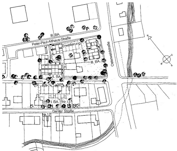
Abb. 12: Lageplan mit den Bauabschnitten I-III
