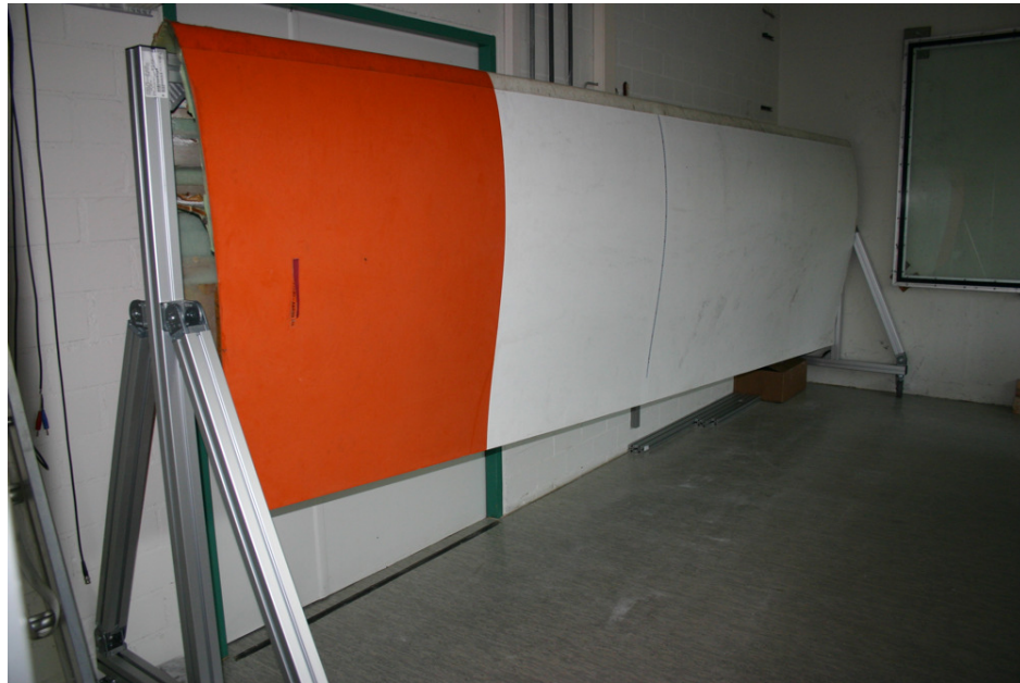
Abbildung 5.12: Rotorblattstück mit einer Länge von 5 m.
