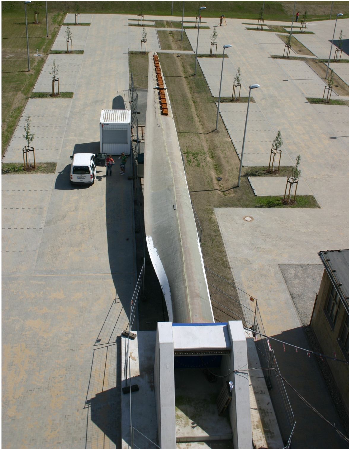
Abbildung 7.1: Rotorblatt im Prüfstand der IMA und des IZFP Dresden.
