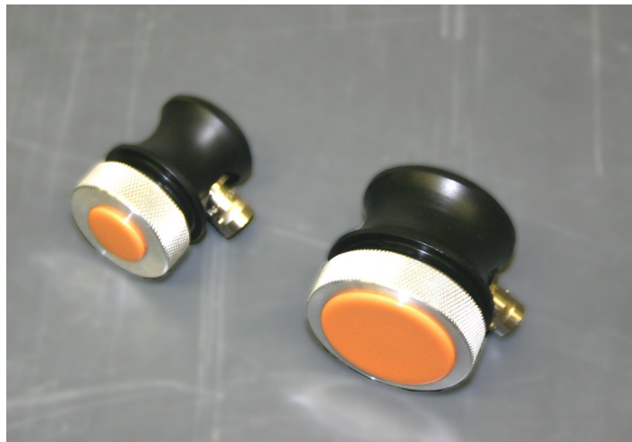
Abbildung 4.4: Foto der Sensoren mit aufgeschraubten Silikonmembranen.
