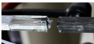
Abbildung 5-15 Bruchbilder von ausgewählten Auszugsversuchen der mit C-Fasern verstärkten Proben; Auswahlkriterien: maximale (relative) Bruchkraft und Versagensstelle
