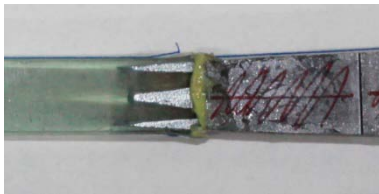
Abbildung 5-20 Bruchbilder von ausgewählten Auszugsversuchen der mit G-Fasern verstärkten Proben; Auswahlkriterien: maximale (relative) Bruchkraft und Versagensstelle
