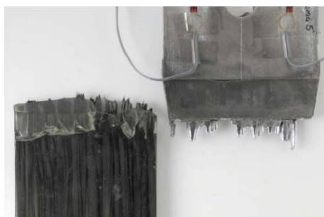
Abbildung 5-26 Bruchbilder der Bauteilversuche mit Carbonfasern
