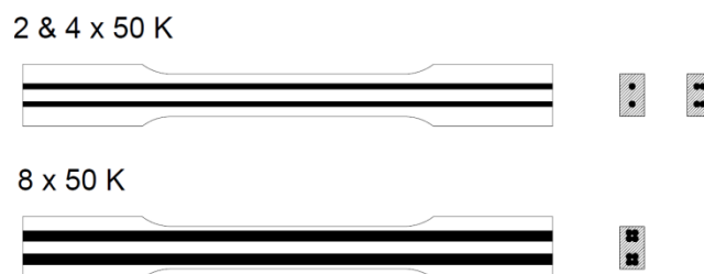
Abbildung 5-2 Faserlage innerhalb der Probekörper für die untersuchten Fasermengen
