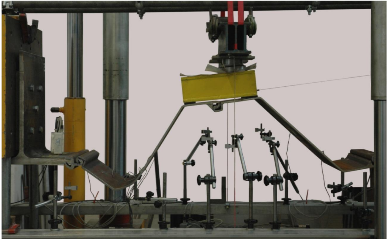
Abbildung 6.11: Versagensmechanismus Versuch Serie III bei 190 mm Maschinenweg – Ansicht von vorne
