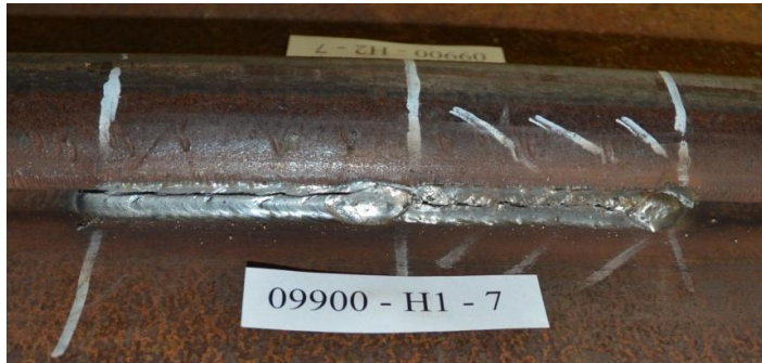
Abbildung 5.20: Bild einer Schweißnaht im Versagenszustand
