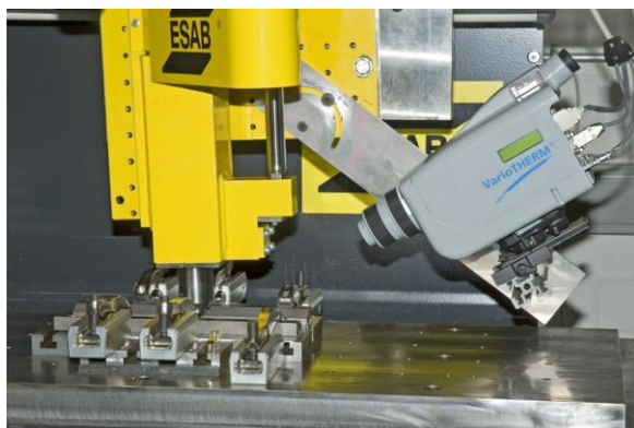
Abb. 4.60 : Messung der Oberflächentemperatur und Vergleich Lage T_{\max} und T_{F\max}
