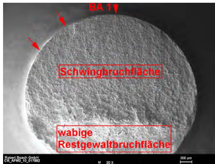
Abbildung 7.16: Ansicht einer Schwingbruchfläche, Vergrößerung: 20x
