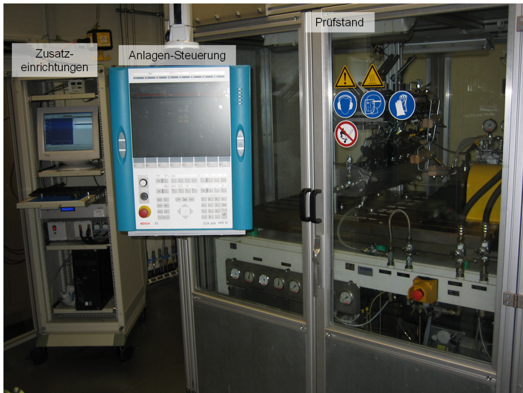
Abbildung 4.1: Prüfstand zur praxisnahen Bauteilerprobung von innendruckbelasteten Common-Rail-Komponenten
