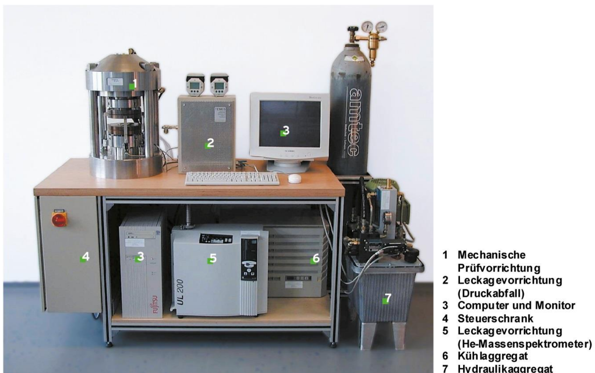
Bild 5.1: Multifunktionsprüfeinrichtung TEMES fl.ai1 zur Ermittlung von Dichtungskennwerten
