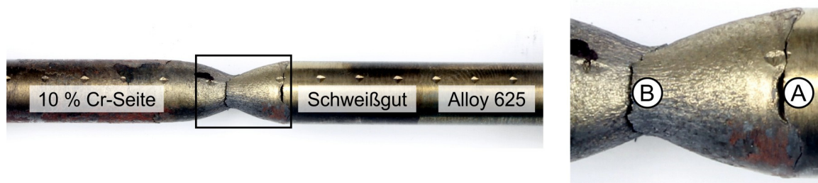
Abbildung 4.10: Bruchaussehen, Probe BSVC-Z1, 295 MPa, 550 °C
