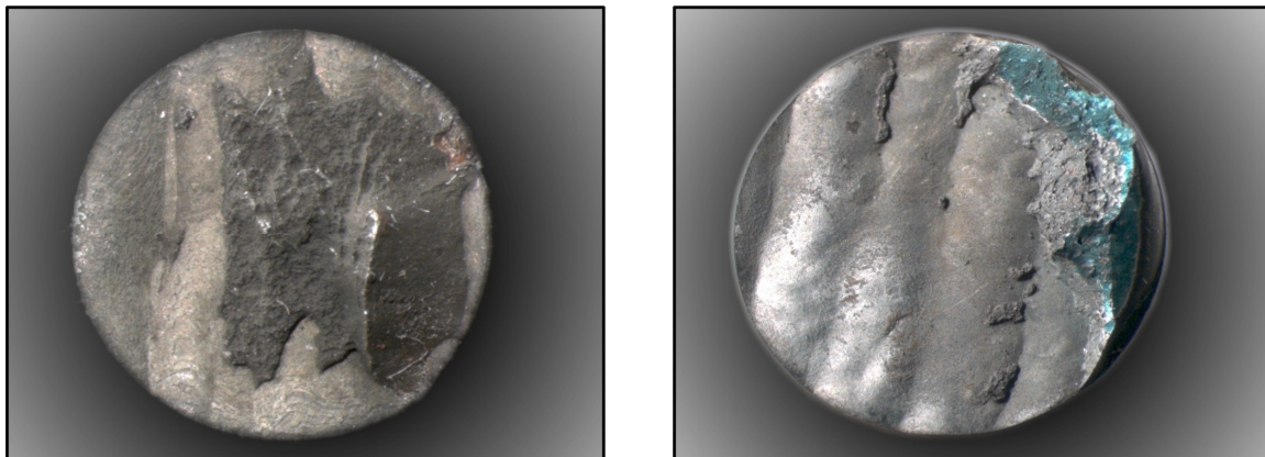
Abbildung 2.21: Zeitstandversagen in der Fusionslinie an zwei unterschiedlichen Mischschweißverbindungen [Kle11a], [Roo09]
