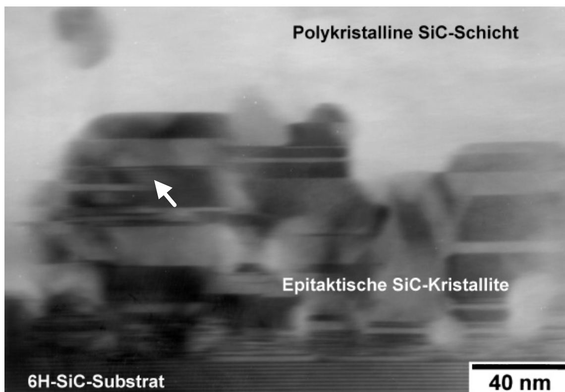
Abb. 67 TEM-Querschnittsaufnahme von SiC-Kristalliten auf 6H-SiC nach 15-minütiger Auslagerung bei 1600 °C, 15 min (Hellfeld-Aufnahme). Precursor: Polymethylvinylsilan. Pol: \{11\bar{2}0\} Pfeil: Zone aus epitaktischem \alpha -SiC
