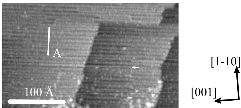
Bild 5.4 RTM-Bild der \text{TiO}_2 (110)-(1x1)-Oberfläche. Parallel zur [001] Richtung liegen die Sauerstoffbrückenreihen in einem Abstand in [1\bar{1}0] -Richtung von 6,5 \pm 0,4 Å.
