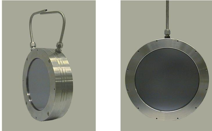
Abbildung 2.5: Ätzzellen: Doppelzelle für zwei 150mm Wafer (links), Einzelzelle für einen 200mm Wafer (rechts)
