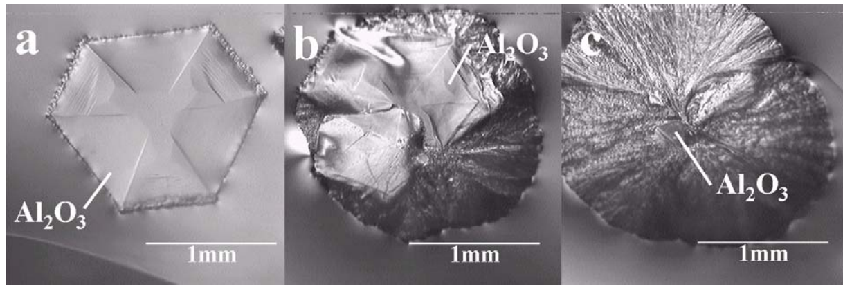
Abbildung 21 a-c: a) Korundkristall schwimmend auf der Oberfläche vom Glas, an den Kanten ist eine weitere Phase heterogen aufgewachsen. b) Der Korundkristall wird in Gegenwart der heterogen aufwachsenden Phase wieder aufgelöst. c) Korund hat sich fast vollständig zersetzt.
