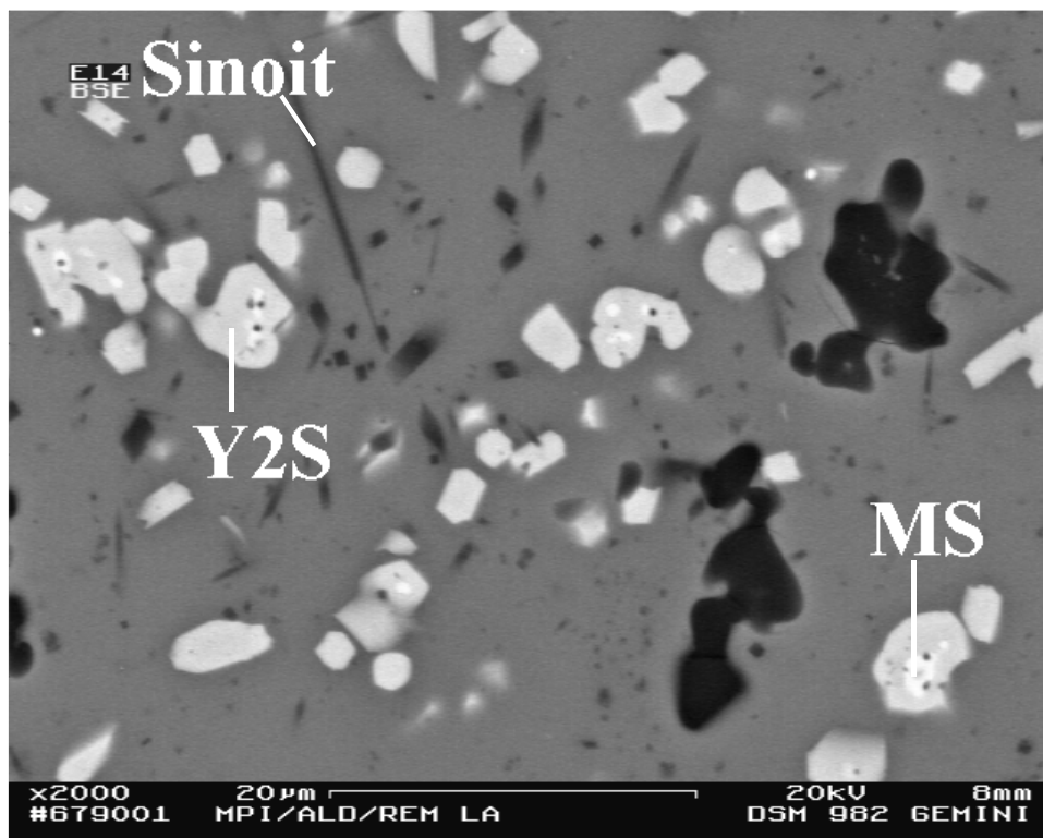
Abbildung 40: REM BSE-Abbildung der bei 1300°C geschmolzenen Probe E14. Hauptbestandteil ist Y2S. (x2000)
