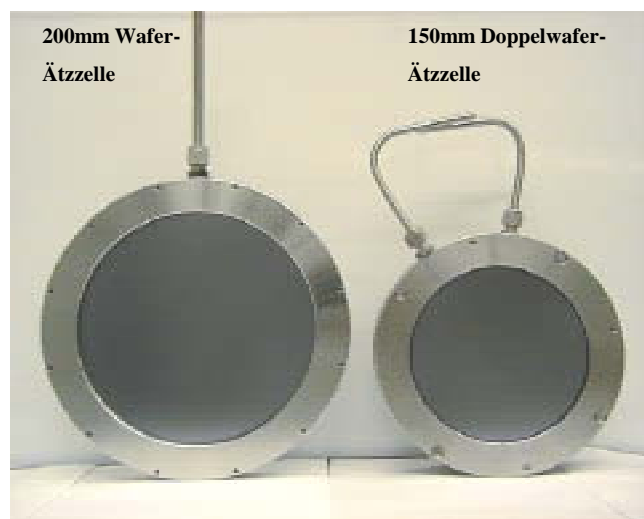
Abb. 68 200mm und 150mm Doppelwafer-Ätzzelle aus Edelstahl
