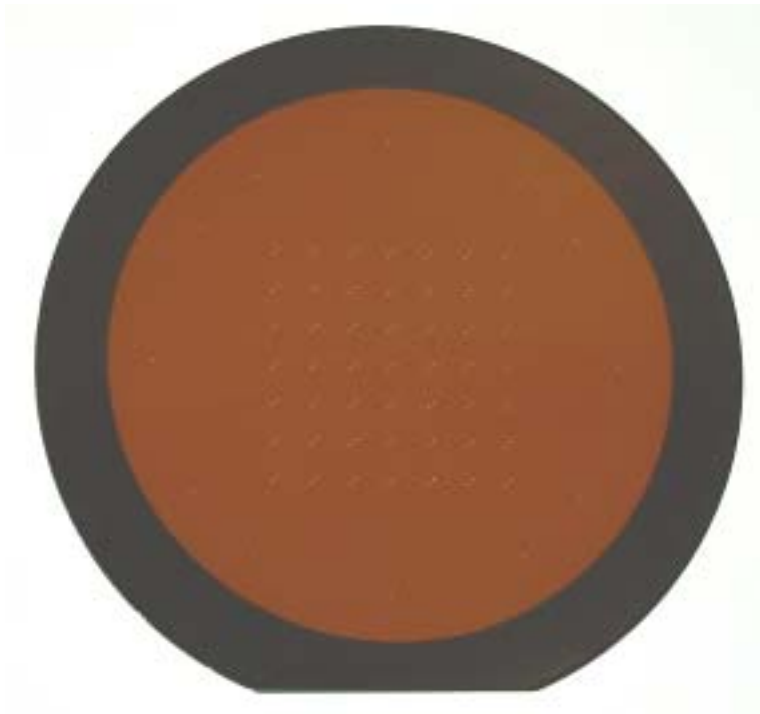
Abb. 110 3 \mu m Stencilmaske gefertigt nach dem Doppel SOI WFP
