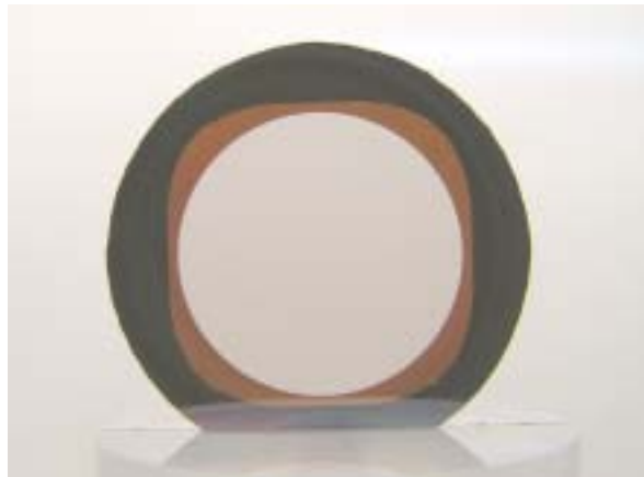
Abb. 153 Vorderseite der Stencilmaske nach Membran- und Oxidätzung
