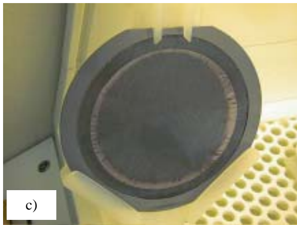
c) Wafer nach 1h 30min 2% TMAH, 80°C
