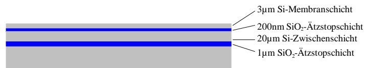
Abb. 105 Doppel SOI Wafer
