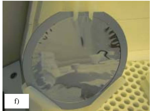
f) Wafer nach 2h 45min 2% TMAH, 80°C
