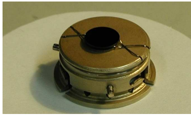
Abbildung 3.2: CoGa \{100\} Einkristall Probe auf einem Molybdän Probenhalter
