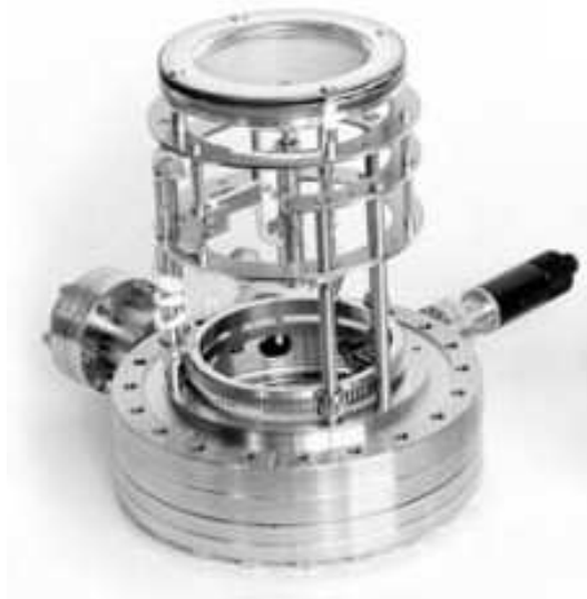
Abbildung 5.8: Kombiniertes LEED, Auger-Spektroskopie System (SPECS GmbH, Berlin).
