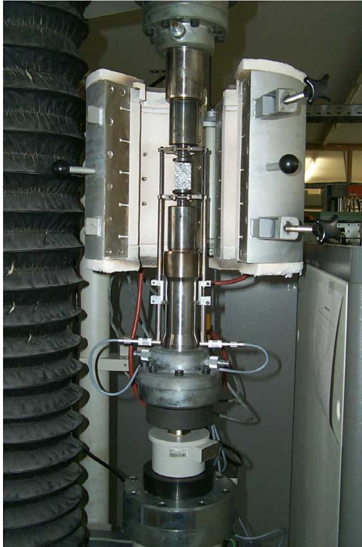
Abbildung 18: Versuchseinrichtung mit aufgeklapptem Dreizonenofen und ein-gebrachter Schaumprobe der Abmessungen 25 \times 25 \times 50 \text{ mm}^3 .
