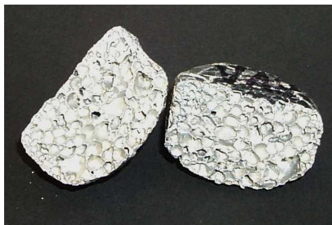
Abbildung 48: Aufgesägte Referenzprobe aus der Gusslegierung AlSi7 zur Überprüfung der Herstellungsparameter.
