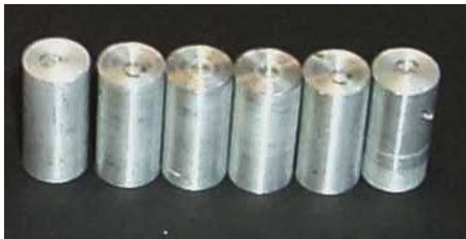
Abbildung 10: Dargestellt sind aus den abgegossenen Ingots herausgearbeitete Vollmaterialproben (Maße: 9 mm Durchmesser, 18 mm Höhe) mit gleicher chemischer Zusammensetzung wie das Zellwandmaterial.
