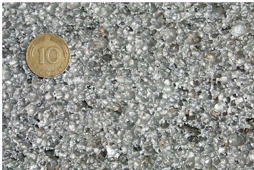
Abbildung 8: Oberfläche des kommerziell hergestellten geschlossenzelligen Aluminiumbasisschaums mit dem Handelsnamen Alporas ® im Lieferzustand. Hier Variante B mit einer relativen Dichte von 0,112.
