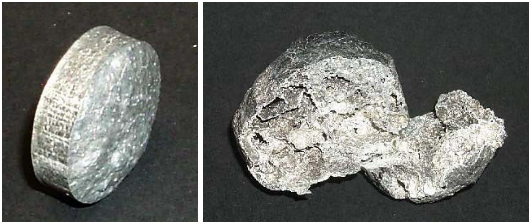
Abbildung 49: Halbzeuge nach dem Aufschäumversuch Linkes Bild: Mechanisch legiertes Pulver nach Pressung und Schäumversuch (520 °C, 300 MPa, 10 min). Rechtes Bild: Mischung mit 50 % Reinaluminium-Pulver (520 °C, 300 MPa, 10 min).
