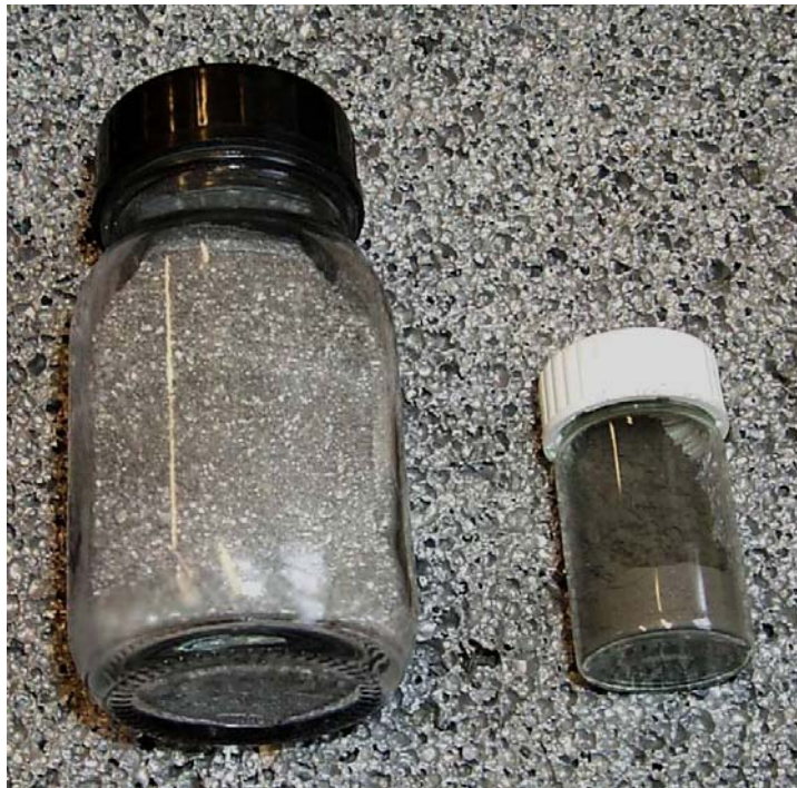
Abbildung 45: Edukte eines dispersionsverfestigten Aluminiumbasisschaums: Links: mechanisch legiertes Aluminumpulver. Rechts: Treibmittel \text{TiH}_2 .
