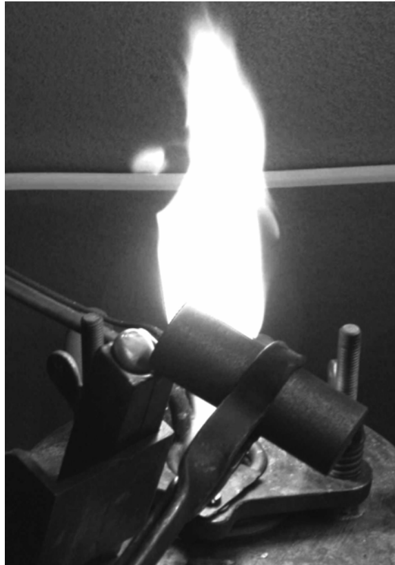
Abbildung 9: Herstellung von Vollmaterial gleicher chemischer Zusammensetzung wie das Zellwandmaterial von Alporas ® -Schaum. Das Bild zeigt den Abgießvorgang in die Kupferkokille.
