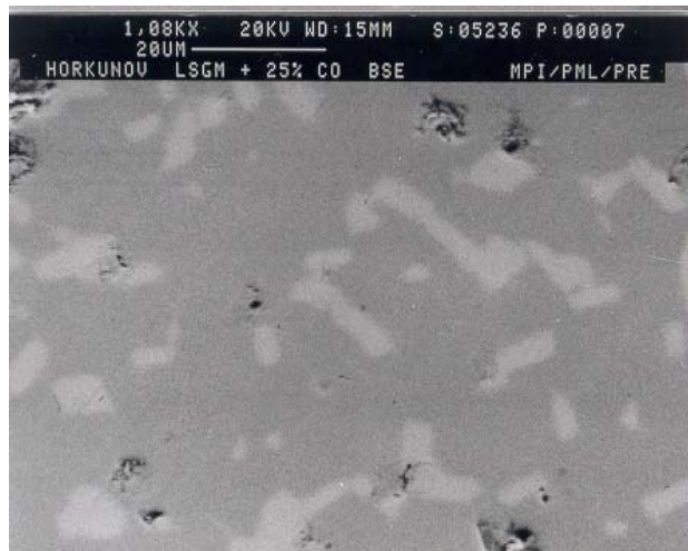
Abb. 6.11: Gefüge von La_{0.8}Sr_{0.2}Ga_{0.60}Mg_{0.15}Co_{0.25}O_{3\pm\delta} (25 mol % Co) mit hellen Körnern von LaSrGaO_4 .
