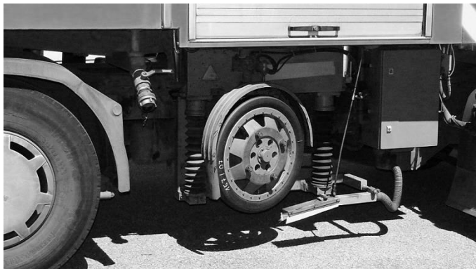
Abbildung 2.6: Messeinrichtung eines Messfahrzeuges für das Seitenkraftmessverfahren und das dazugehörige Messprinzip [41]
