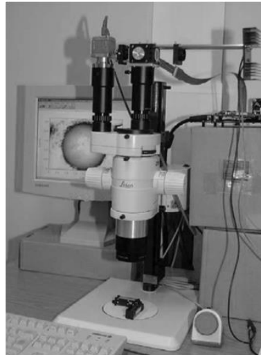
Abbildung 4.3: Streifenprojektion (verwendete Messeinrichtung)
