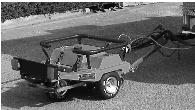
Abbildung 2.7: Beispiel eines GripTesters mit dem dazugehörigen Messprinzip [40,70]
