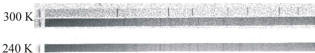
Abb. A(6.6.2) 1 Guinier-Aufnahmen von \text{GdI}_2\text{H}_{0.28} (C4), gemessen bei verschiedenen Temperaturen (Standard: Si).
