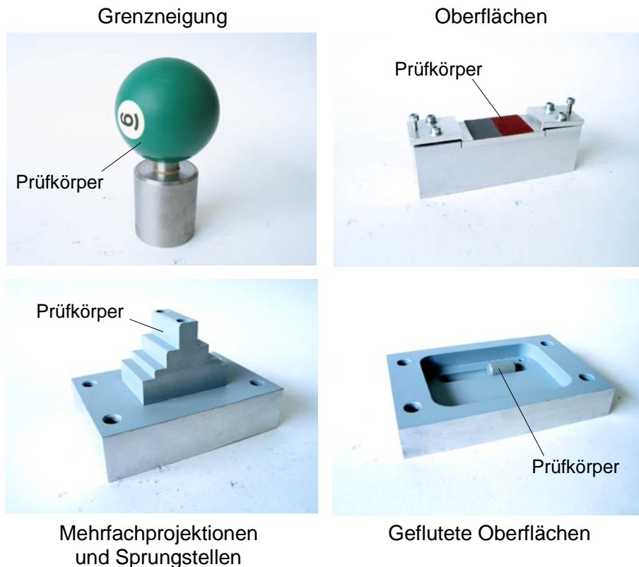
Bild 6.2: Verschiedene Prüfkörperhalter des Versuchsaufbaus mit Beispielen für Prüfkörper und deren Anwendungsbereich
