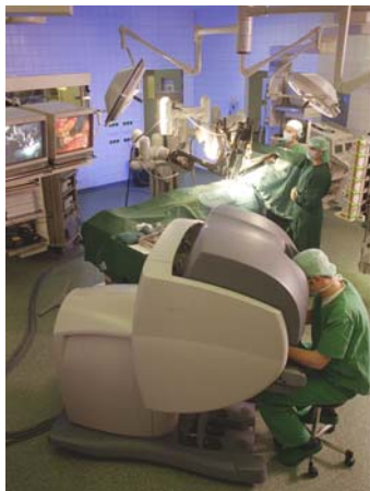
Bild 2.3: Die Manipulatoren daVinci ® (Quelle: Intuitive Surgical) und Zeus ® (Quelle: Computer Motion)
