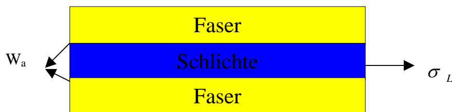
Abb. A5: Grenzflächenadhäsionsarbeit zwischen Faser und Schlichte
