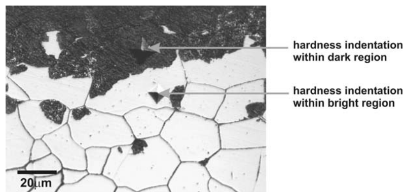
Bild 7.3: Lichtmikroskopische Aufnahme zweier Härteeindrücke im gleichen Korn (eingebracht mit dem gleichen Gewicht), mit diskontinuierlich vergrößerten Ausscheidungen und submikroskopischen Ausscheidungen einer nitrierten Fe-4Gew.%Cr Legierung. Der Härteeindruck im dunkleren Bereich (diskontinuierlich vergrößert) ist deutlich größer im Vergleich zum Härteeindruck im hellen Bereich.
