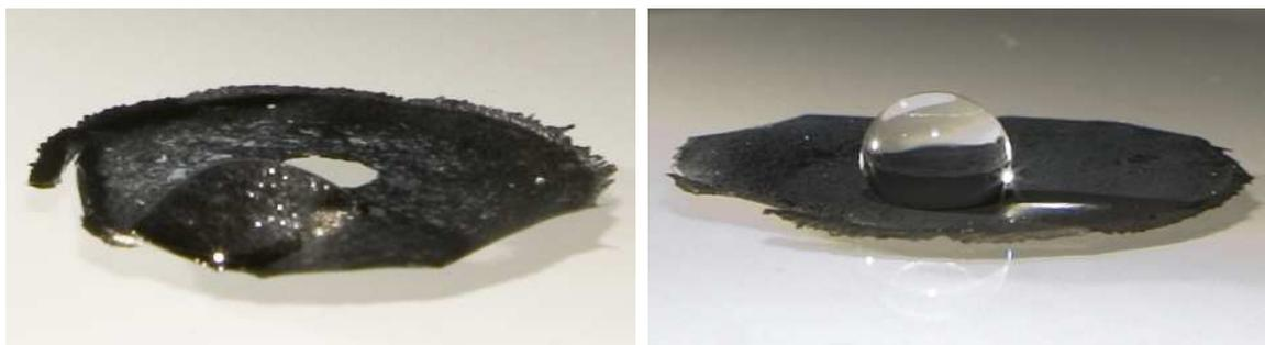
**Abbildung 6.51:** Wassertropfen auf der hydrophiler Vorderseite (links) und teflonierter hydrophober Rückseite (rechts) der CNT–Gasdiffusionselektrode.
