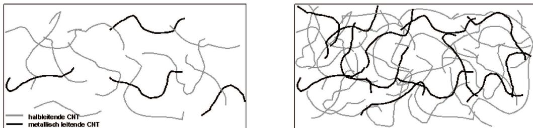
**Abbildung 6.8:** Ausbilden eines metallisch leitenden Strompfades (schwarze Linien) mit zunehmender CNT Dichte.
