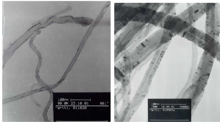
**Abbildung 4.11:** TEM–Aufnahmen im CVD–Verfahren gewachsener MWCNTs.
