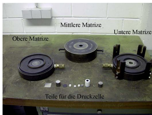
**Abb. 2.2:** Bild der oberen, mittleren und unteren Matrize und den notwendigen Teilen für den Einbau der Probe.
