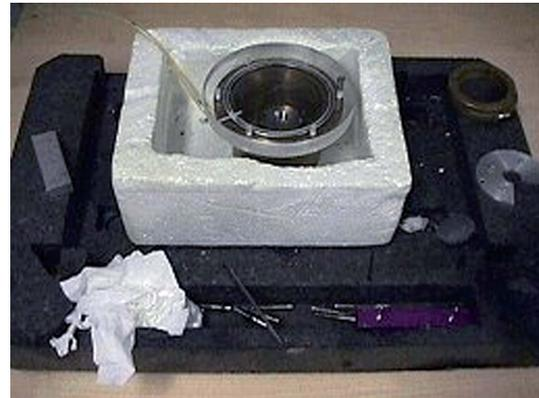
**Abb. 2.11:** Abbildung einer für das kryogene Befüllen mit flüssigen Stickstoff vorbereiteten Diamantstempelzelle.
