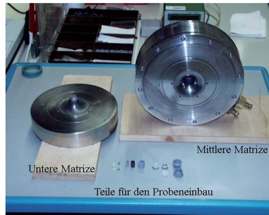
**Abb. 2.5:** Belt-Modul mit mittlerer und
