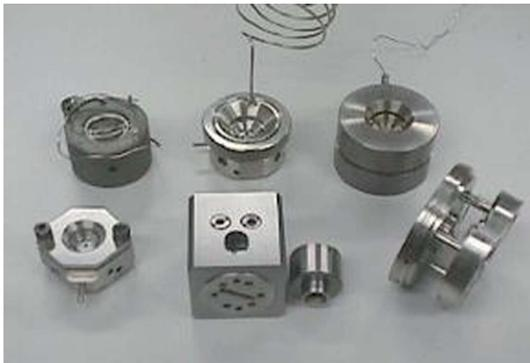
**Abb. 2.10:** Abbildung der verwendeten Typen von Diamantstempelzellen für die Versuche.
