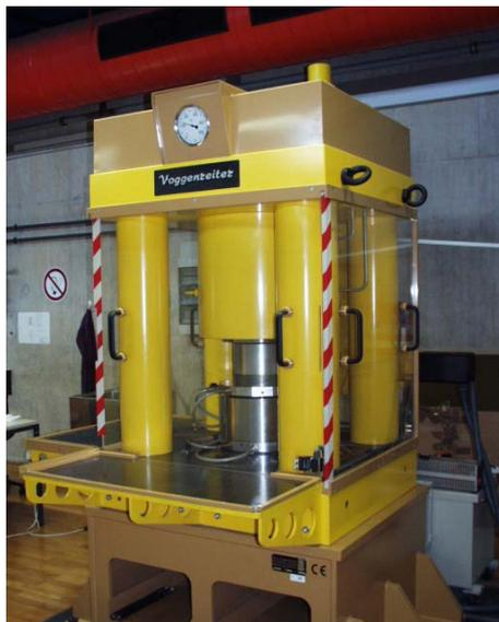
**Abb. 2.7:** Multianvil-Pressen, ausgestattet mit einem Walker-Modul für 32mm WC-Würfel; einsetzbar für Drücke bis zu 27 GPa and 2500 °C.
