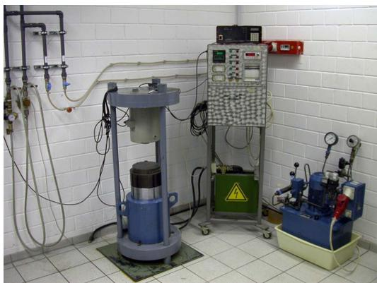
**Abb. 2.1:** Bild der verwendeten Piston-Zylinder-Pressen für Drücke bis ca. 2,5 GPa und 1000 °C.
