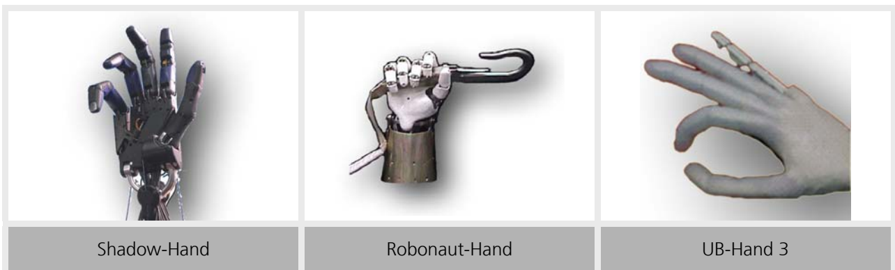
Abbildung 2-6: Beispiele für künstliche Hände in integrierter Bauweise.
