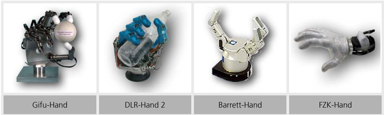
Abbildung 2-5: Beispiele für künstliche Hände in modularer Bauweise.
