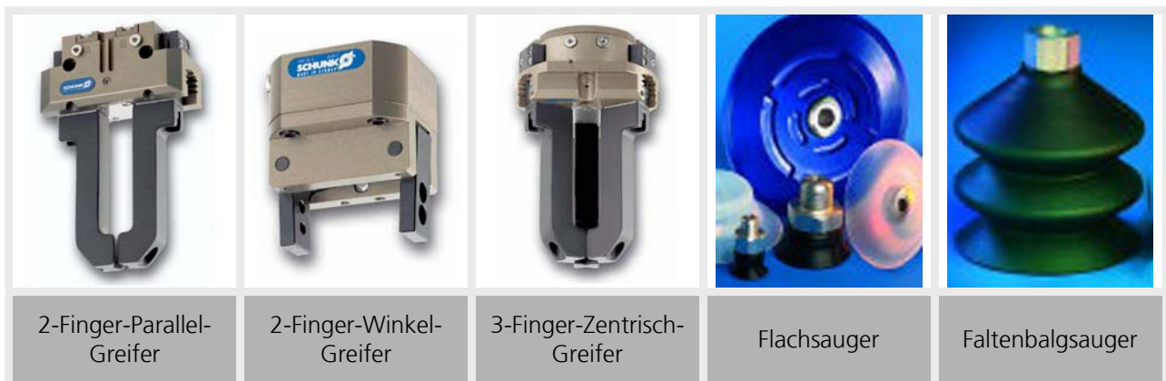
Abbildung 2-3: Beispiele von mechanischen Greifern /Schunk 2005/ und Sauggreifern /Schmalz 2005/.
