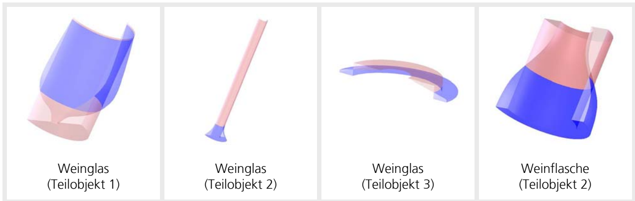
Abbildung 3-3: Approximation von Regelgeometrien an ein segmentiertes Weinglas und das Teilobjekt 2 der Weinflasche.
