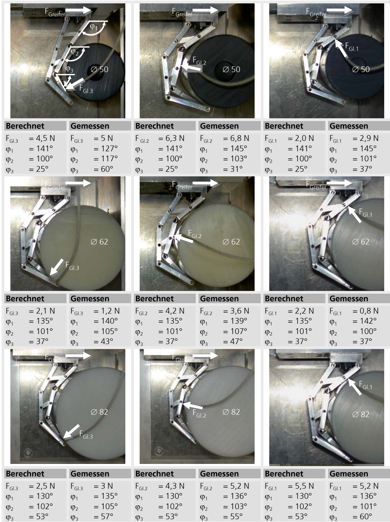
Abbildung 6-5: Vergleich zwischen berechneten und gemessenen Kräften und Winkeln für drei unterschiedliche Objektdurchmesser
