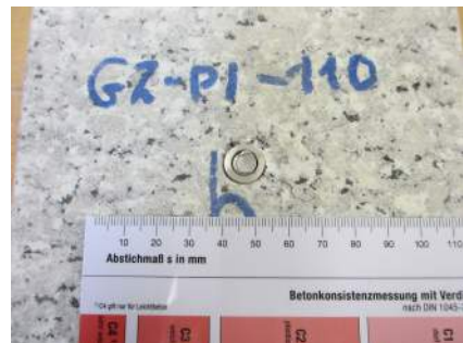
(b) „Granit 2“, Stahlversagen
