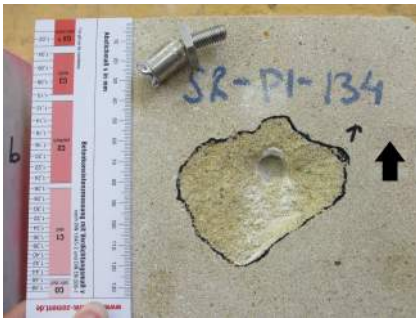
(c) „Sandstein 2“, Steinausbruch und (d) „Sandstein 1“, Eckige Hinterschnitt-muschelförmiger Ausbruch
