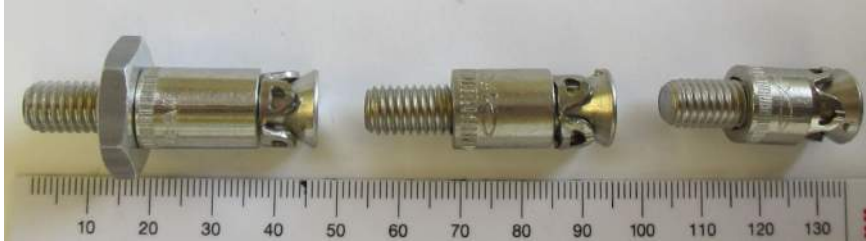
Abb. 5.4.: Die verwendeten Anker: Typ B 13x26 M8/SO/17 AL (l.), Typ B 13x20 M8 A4 (m.), Typ B 13x15 M8/15 A4 (r.)
