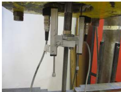
Abb. 5.10.: Halterung der Wegaufnehmer
