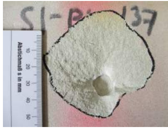
Abb. 6.21.: Ausbruchbild bei Querlast, SSandstein 1"
