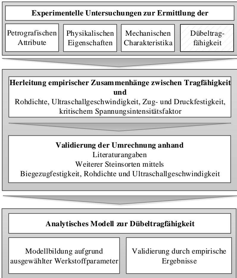
Abb. 6.1.: Übersicht der durchgeführten Arbeiten
