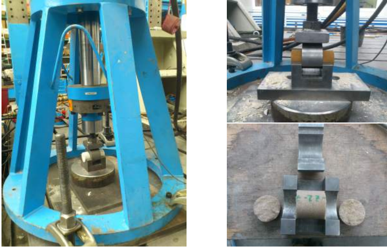
Abb. 4.51.: Bestimmung der Scherfestigkeit: Versuchsaufbau und Bruchbild
