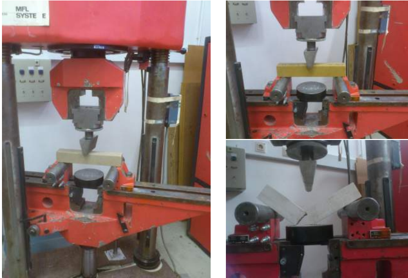
Abb. 4.39.: Bestimmung der Biegezugfestigkeit: Versuchsaufbau und Bruchbilder
