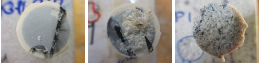
Abb. 4.46.: Ungültige (r., m.) und gültige Bruchbilder (l.) mit einem Stempeldurchmesser von 20 mm
