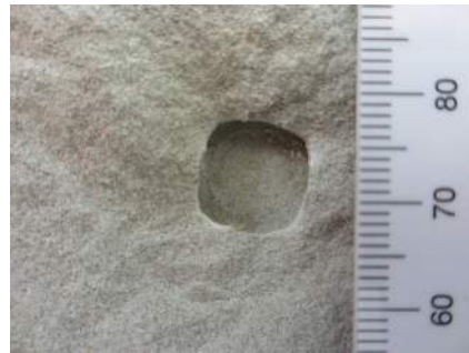
(c) „Sandstein 2“, Steinausbruch und (d) „Sandstein 1“, Eckige Hinterschnitt-muschelförmiger Ausbruch
