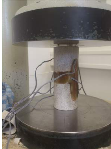
(b) K3-Probe mit 120 mm Höhe
