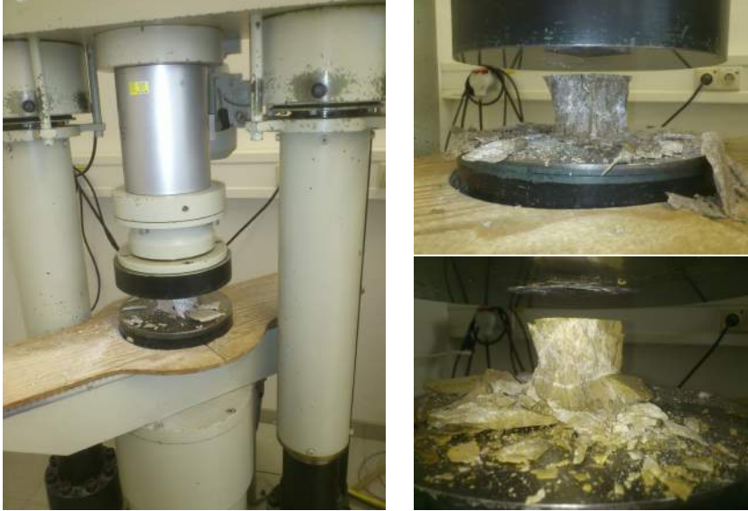
Abb. 4.31.: Bestimmung der einachsigen Druckfestigkeit: Prüfmaschine und Bruchbilder
