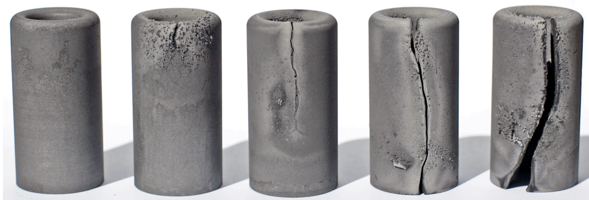
Abb. 16: Rissbildung in Kohlenstoffverdampfungskörpern – links unbenutzter Verdampfungskörper bis rechts extrem gerissener Verdampfungskörper.
