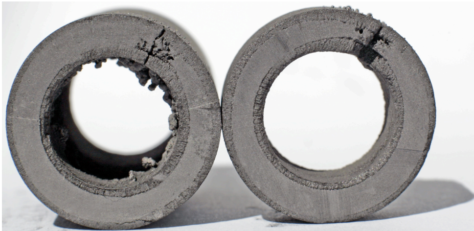
Abb. 18: Querschnitt eines Verdampfungskörper mit Riss.
