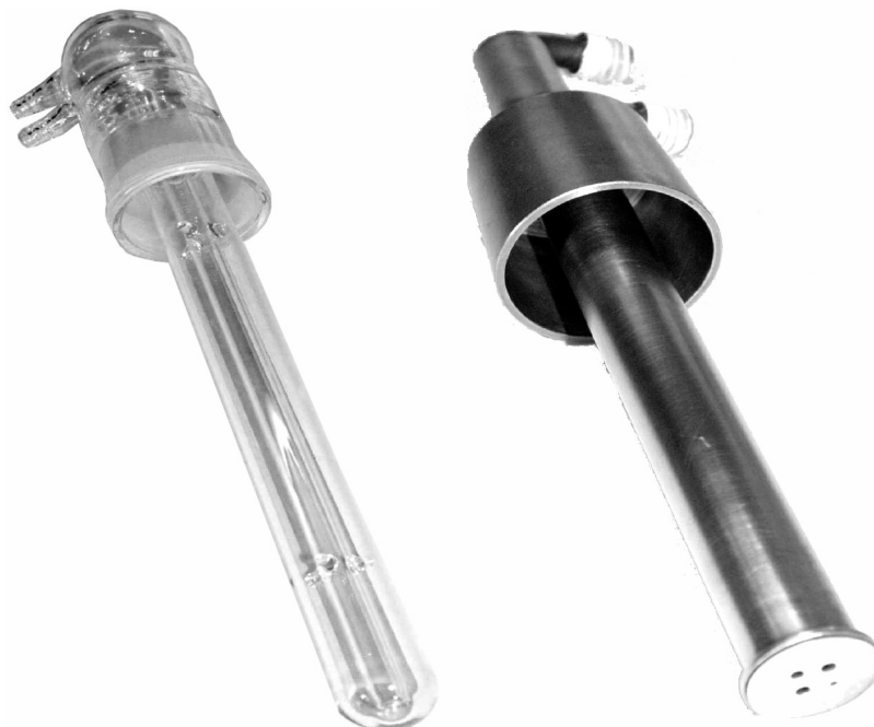
Abb. 13: Links: Glaskühlfinger (Typ a) mit Schliffverbindung. Rechts: Messingkühlfinger (Typ b) mit MS-Probenträger.
