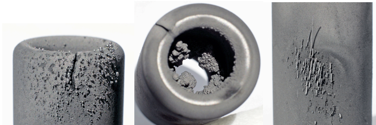
Abb. 20: Aufwachsungen außen und innen am Verdampfungskörper.
