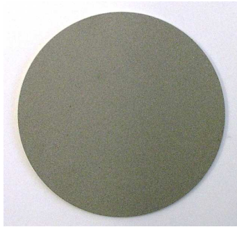
Bild 3-16 Trägersubstrat (ITM 14) der Firma Plansee, ausgeführt als poröse Ronde ( \varnothing = 48 mm, t = 1 mm, Porosität \sim 50 Vol.-%)
