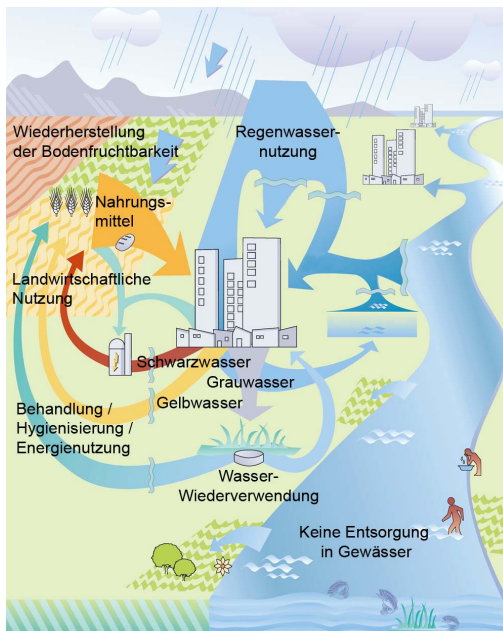
Abbildung 2.5: Umsetzung der Ecosan-Prinzipien im Nährstoff- und Wasserhaushalt von Siedlungen [13]
