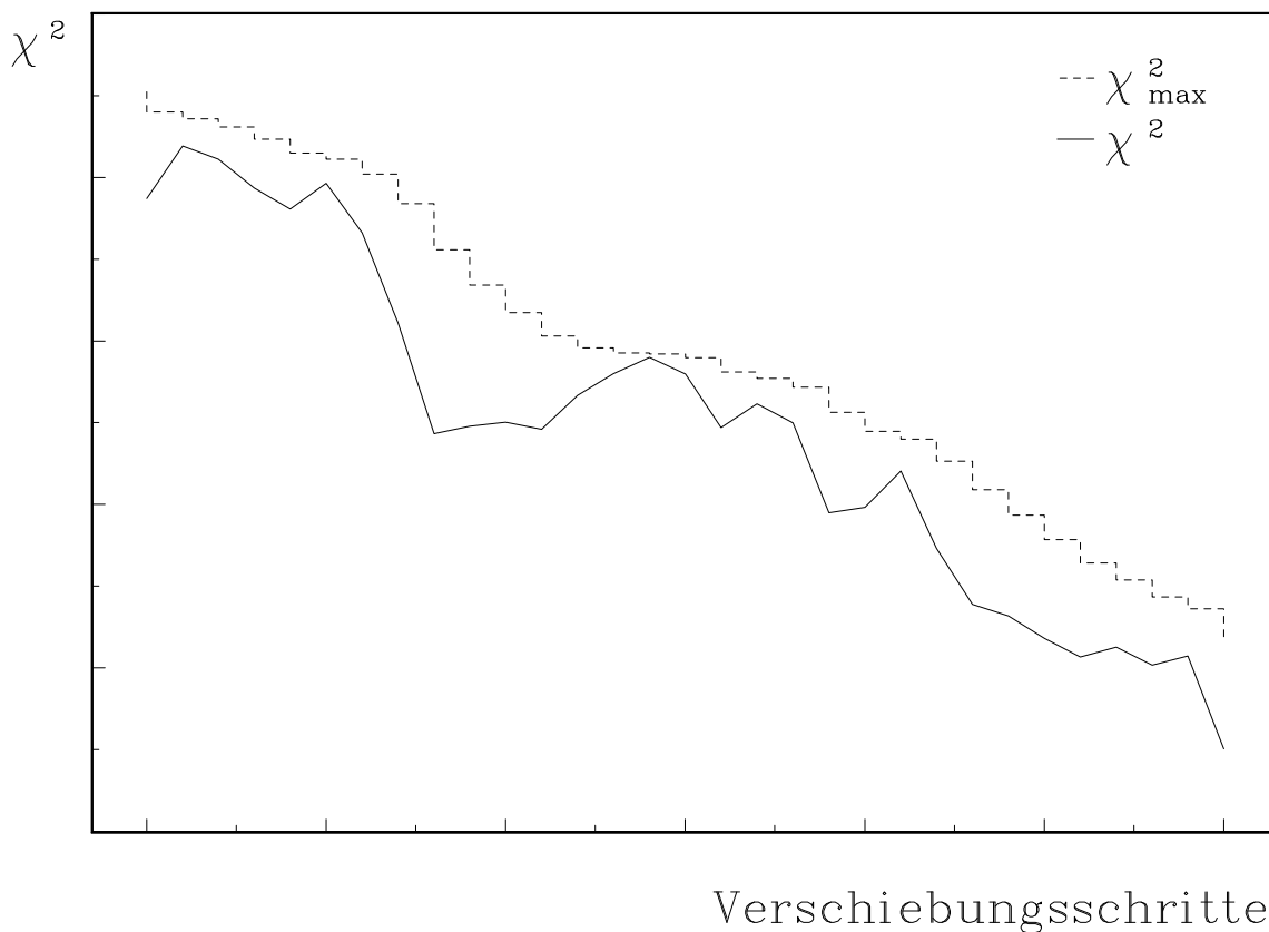
Abbildung 5: Schematischer Verlauf des \chi^2 -Wertes mit dem Sintflut-Algorithmus
