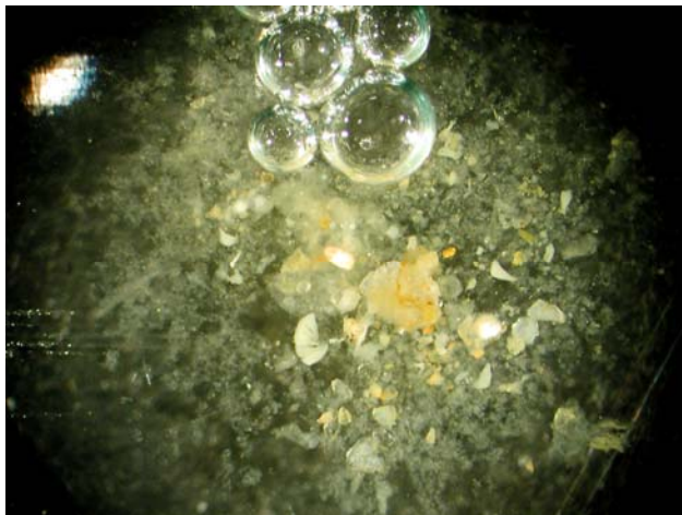
Abb. 1498.Probe 02.1: HCl- Auszug: silicatische Zuschläge, feinteiliges Bindemittel und Gips; Blasenbildung durch Proteinzusatz (LM).
