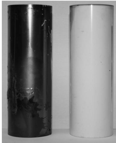
**Abb. 7.1.** Äußerer PBN-Hitzeschild vor der Synthese (rechts) und nach der Synthese (links) mit Graphitablagerung.
