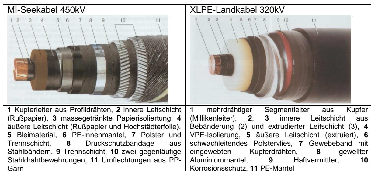
Abbildung 58: Masseimprägnierte und Polyethylen vernetzte Kabel (Kliesch, 2012)
