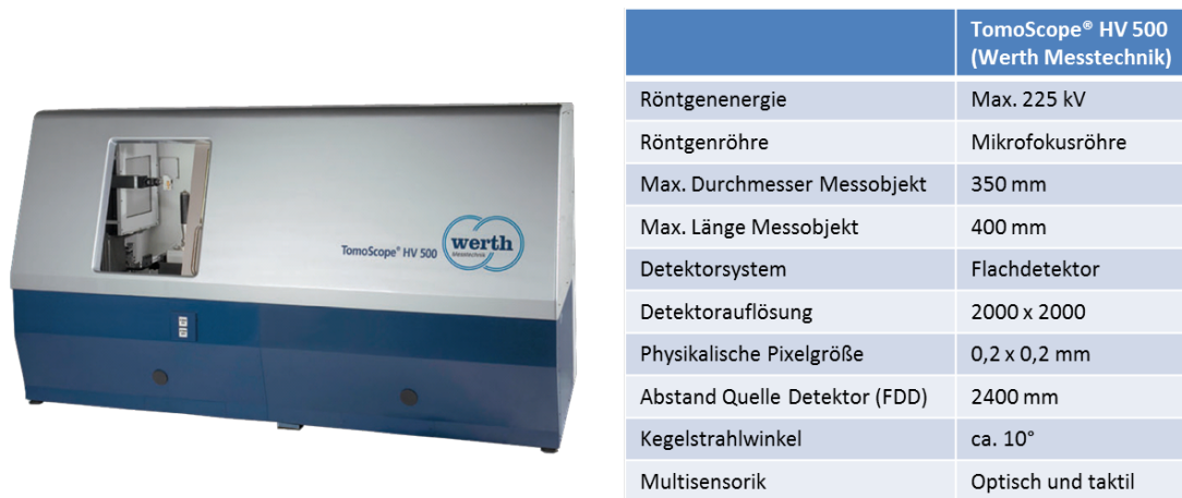
Abbildung 6.1: Genutztes Messsystem TomoScope®HV 500 der Firma Werth Messtechnik GmbH
