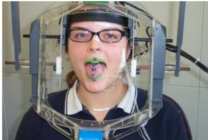
Abbildung 8: EMA-Apparatur und Sprecherin mit den aufgeklebten Messspulen (weiß) und den darunter liegenden Seidenstoffstücke (schwarz). Am unteren Bildrand ist eine der drei Sendespulen erkennbar.
