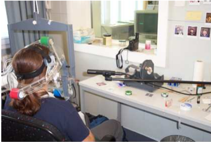
Abbildung 7: Messaufbau. Zu sehen sind das Mikrofon, die Videokamera, der Bildschirm, auf dem die zu sprechenden Pattern erscheinen und die drei Sendespulen am Helm des EMA.
