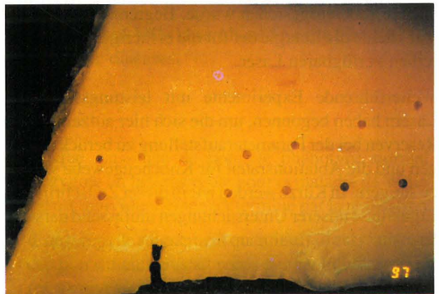
Abb. 5 Rinderrippenknochen mit 13 Bohrungen (Maßst. 4:1).
