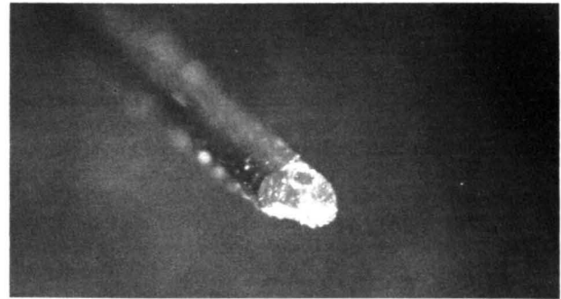
Abb. 2: Zerstörung der Faserendfläche
