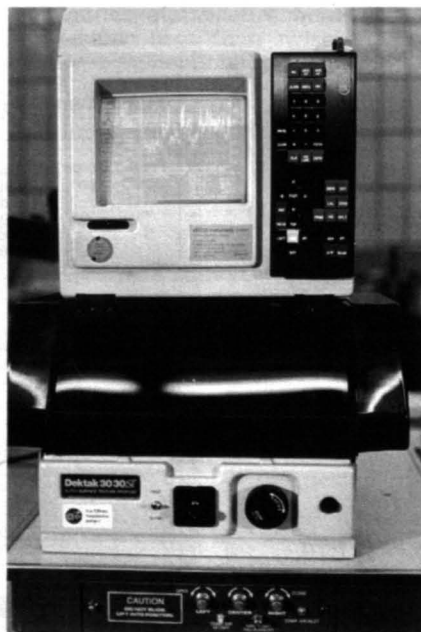
Abb. 3: Oberflächenmeßgerät DEKTAK 3030 ST (Bildnachweis: Veeco Instruments GmbH)
