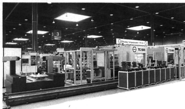
Bild 9 Meßroboter in einem Flexiblen Fertigungssystem Measuring robot in flexible manufacturing system Robot de mesure dans un système de fabrication flexible
